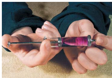
Rys. 2.4. Przesunięcie tłoka w zatkaanej strzykawce wypełnionej cieczą jest bardzo trudne, ponieważ ciecze są nieściśliwe
