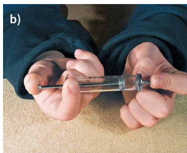
Rys. 2.5. Objętość powietrza w strzykawce (a) można znacznie zmniejszyć przez ściśnięcie tłoka (b), ponieważ gazy są ściśliwe
