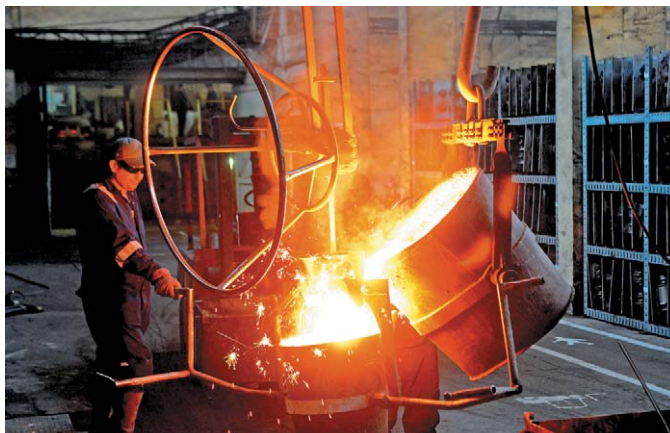
Rys. 2.7. Żelazne przedmioty użytku codziennego powstają przez wlewanie płynnej surówki żelaza do odpowiednich form, w których przebiega proces krzepnięcia
