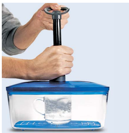
Rys. 2.9. W naczyniu próżniowym woda może wrzeć w temperaturze niższej niż 100\text{ }^{\circ}\text{C}
