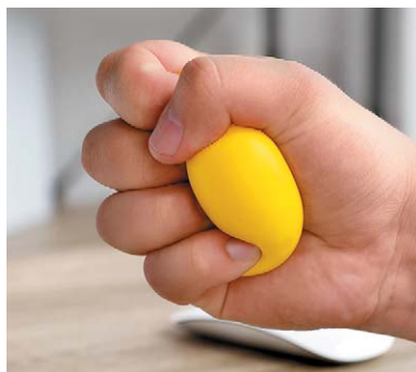
Rys. 2.2. W wyniku ściśnięcia dłonią piłeczka odkształca się, a po jej puszczeniu wraca do swojego pierwotnego kształtu.
