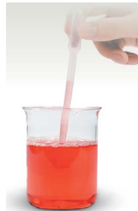
Rys. 1.19. Podciśnienie wewnątrz pipety powoduje zaciągnięcie płynu do rurki
