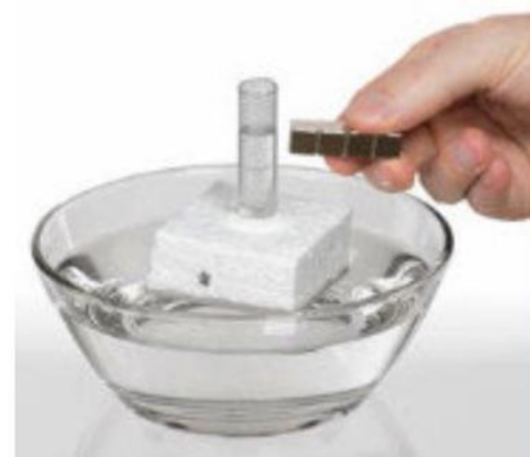
Woda w rurce wbitej w styropian jest odpychana przez magnes neodymowy.
