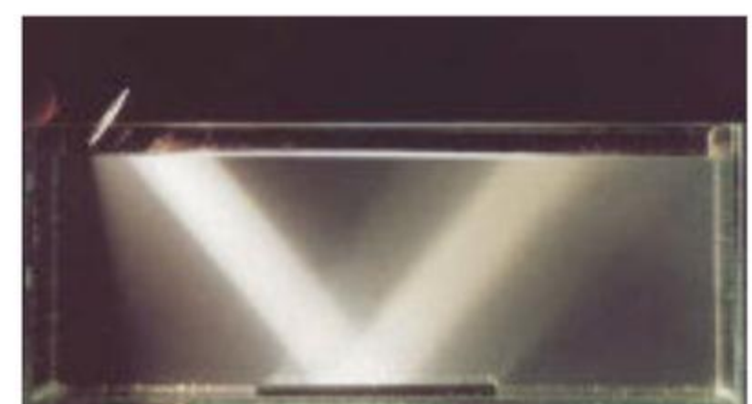
Zjawisko odbicia światła laserowego i latarki od lusterka ułożonego na dnie akwarium.
