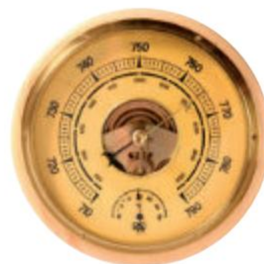
Ciśnienie atmosferyczne mierzy się za pomocą barometru.
