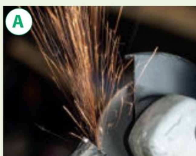
iskra (stalowy opiłok) o temperaturze 1000°C
