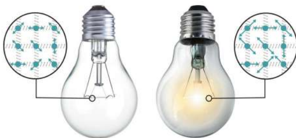
Ryc. 37.5. Różne energie kinetyczne cząsteczek tworzących wolframowe włókna żarówki oznaczają, że włókna mają inne temperatury.
