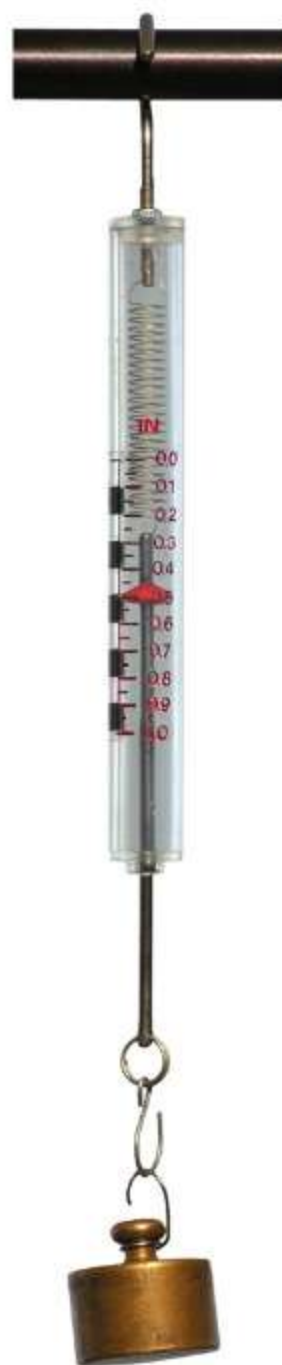
Ryc. 4.1. Siłomierz służy do pomiaru wartości siły.
