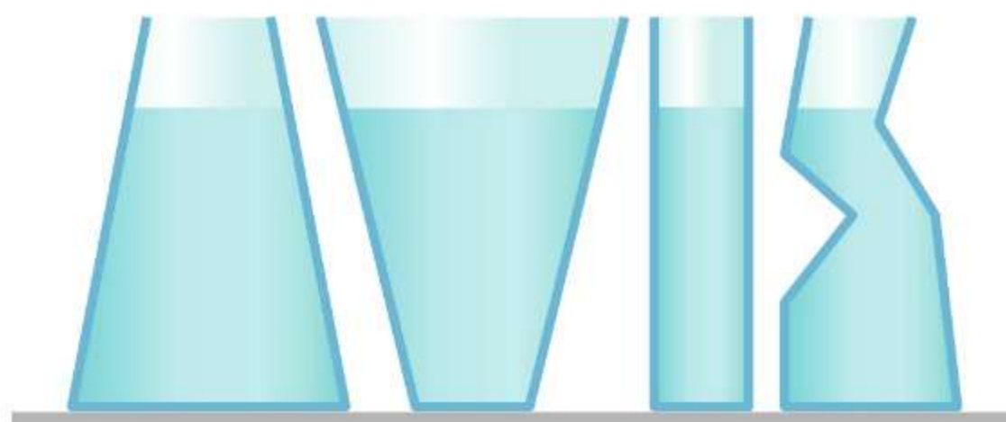
Ryc. 3. Ciśnienie wywierane na dno tych naczyń jest jednakowe, choć siły parcia na dno są różne.
