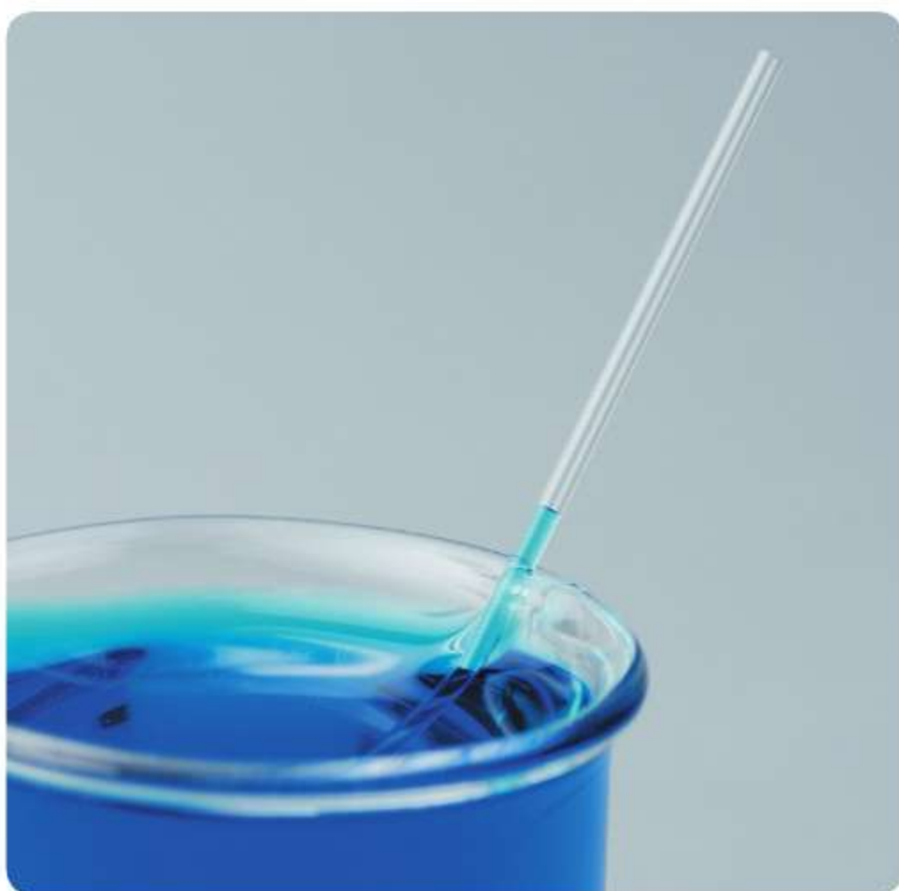
Ryc. 7.5. Unoszenie się wody w wąskiej rurce jest spowodowane istnieniem sił przylegania.
