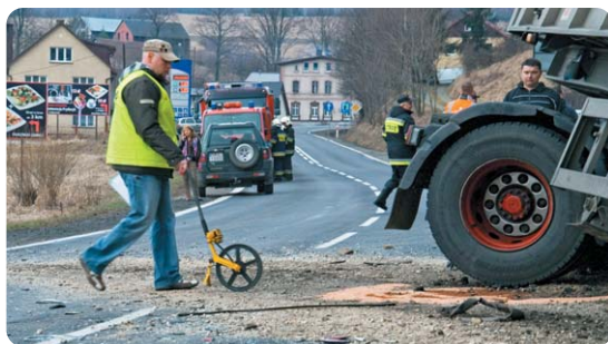
Rys. 14.5. Pomiar drogi hamowania pojazdu uczestniczącego w kolizji
