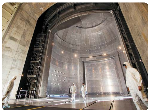
Rys. 29.1. Wnętrze największej na świecie komory próżniowej
