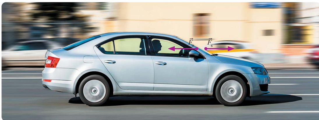
Rys. 4.6. Samochód jedzie w prawą stronę, a siła oporu ruchu \vec{F}_o działa na niego w lewą stronę.
