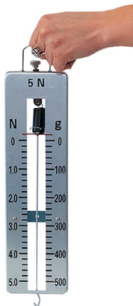
Rys. 4.4. Siłomierz wyskalowany w jednostkach siły (N) i jednostkach masy (g)
