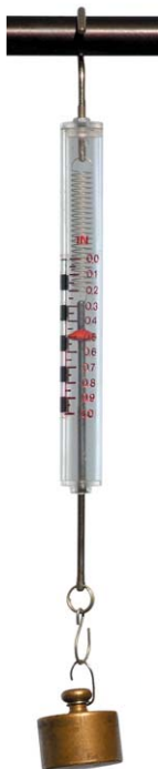
Rys. 4.1. Siłomierz służy do pomiaru wartości siły.
