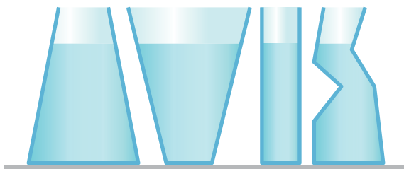
Rys. 3. Ciśnienie wywierane na dno tych naczyń jest jednakowe, choć siły parcia na dno są różne.
