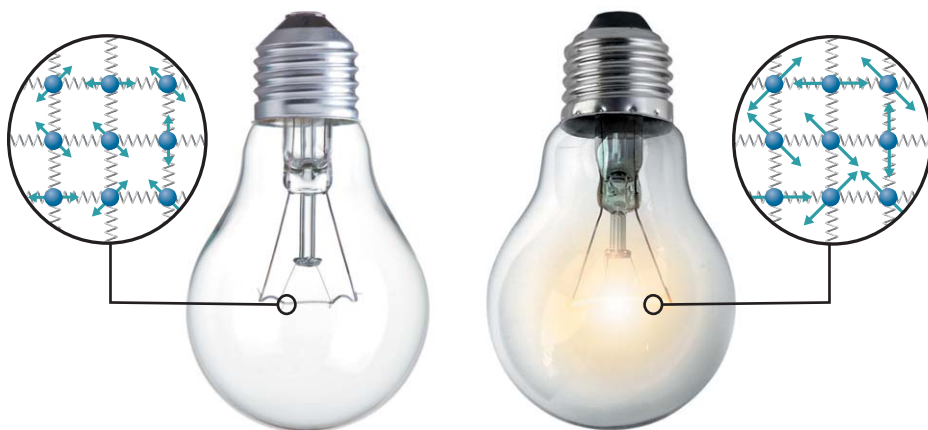
Rys. 36.5. Różne energie kinetyczne cząsteczek tworzących wolframowe włókna żarówki oznaczają, że włókna mają inne temperatury.
