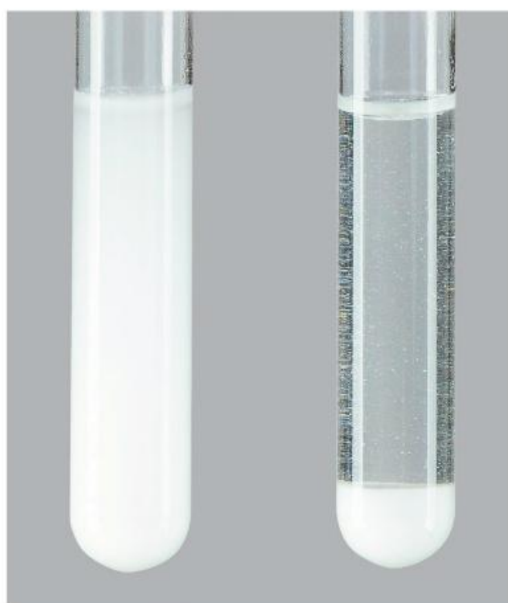
2.12 Po lewej – zawiesina wodorotlenku magnezu (na chwilę po połączeniu dwóch roztworów), po prawej – osad na dnie probówki po kilku minutach
