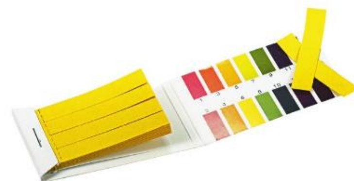
4.5 Uniwersalny papierek wskaźnikowy po zanurzeniu w metanolu i etanolu wskazuje wartość pH = 7
