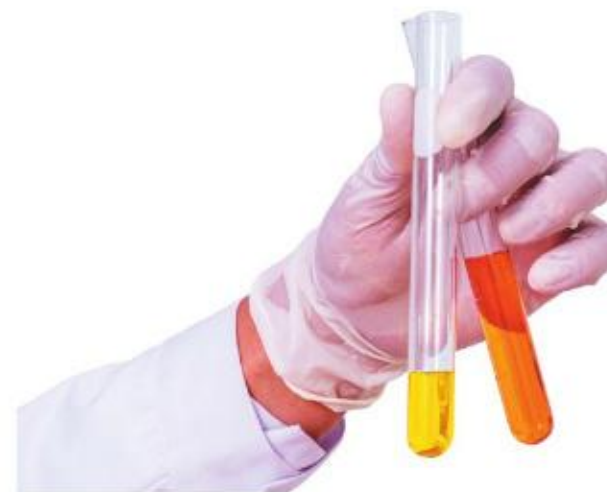
3.16 Woda bromowa to inaczej wodny roztwór bromu. Jej zabarwienie zależy od ilości niemetalu w mieszaninie. Przy małym stężeniu barwa jest herbaciana, przy większym odcień się intensyfikuje
