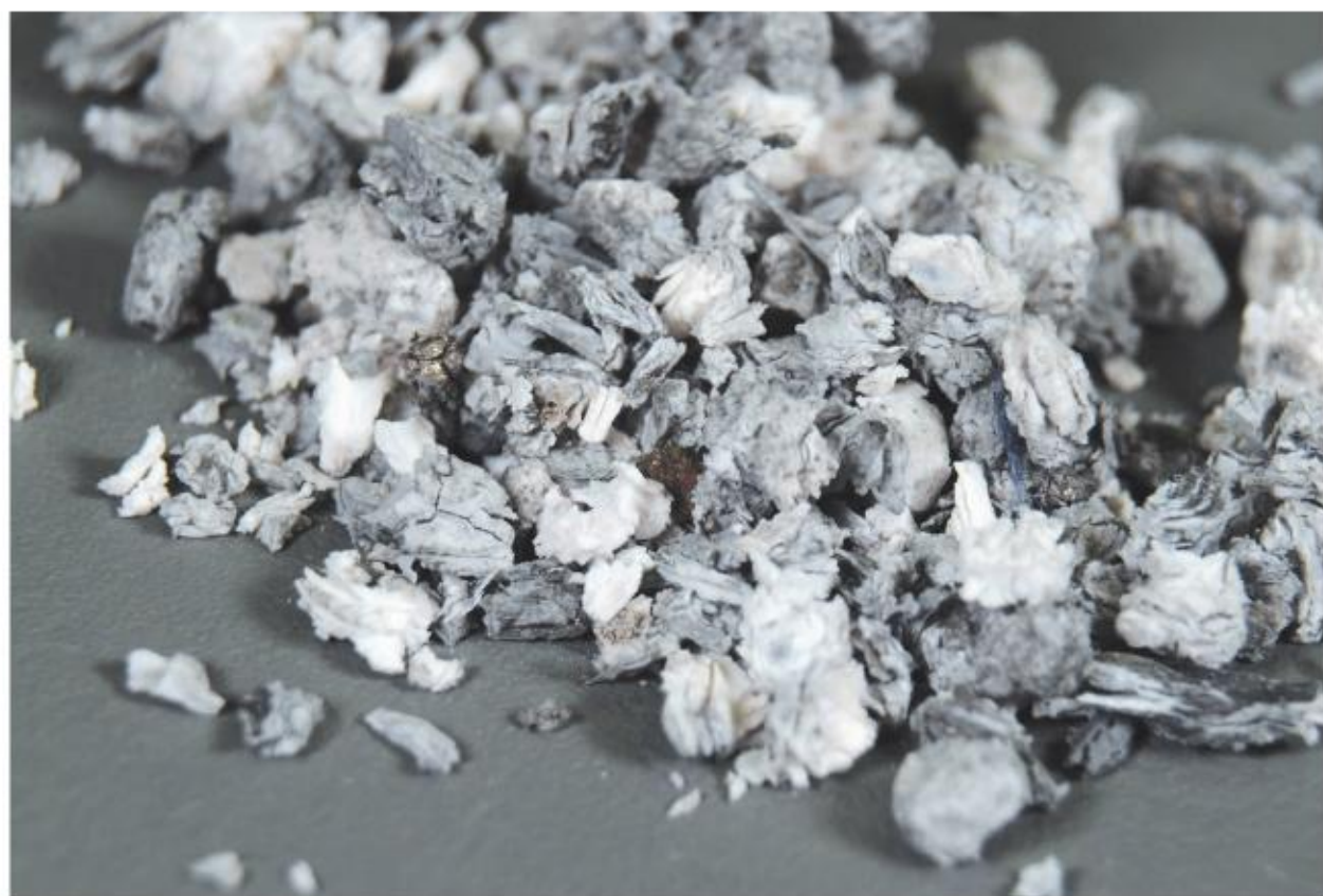
1.9 Wapń, pozostając w kontakcie z tlenem z powietrza, momentalnie traci połysk i pokrywa się jasnym nalotem (tlenkiem wapnia)
