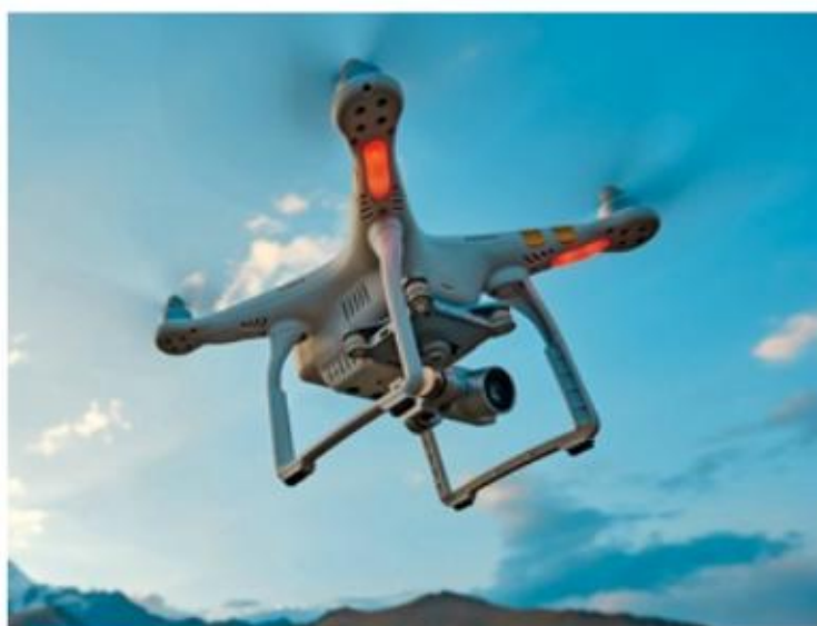
Dron – bezzałogowy statek powietrzny (w trakcie nagrywania obrazu z wysokości)
