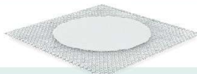
Siatka z płytką ceramiczną jako nakładka na trójnóg do równomiernego ogrzewania dna naczynia
