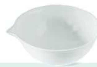
Parownica do odparowywania cieczy
