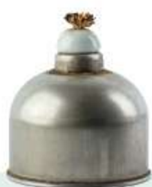
Palnik spirytusowy do podgrzewania substancji i mieszanin w małych naczyniach
