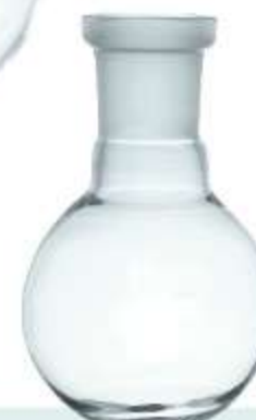
Kolba okrągłodenna do ogrzewania cieczy
