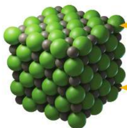
model kryształu jonowego NaCl
