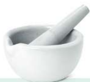
Moździerz do rozdrabniania i ucierania substancji stałych
