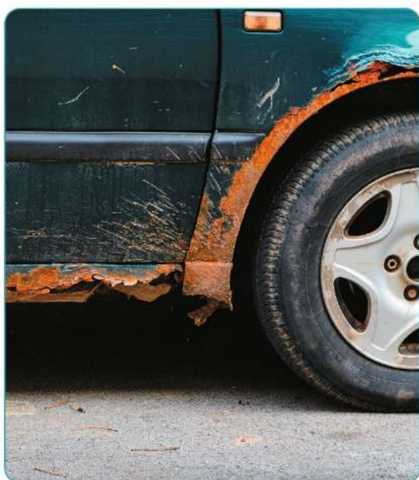
Korozja karoserii samochodu
