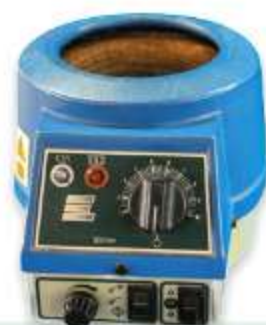
Czasza grzejna do ogrzewania cieczy w kolbach okrągłodennych
