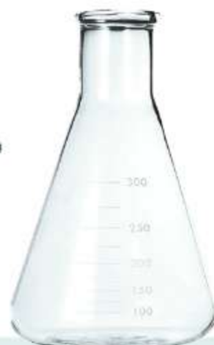
Kolba stożkowa do przechowywania lub ogrzewania substancji i mieszanin
