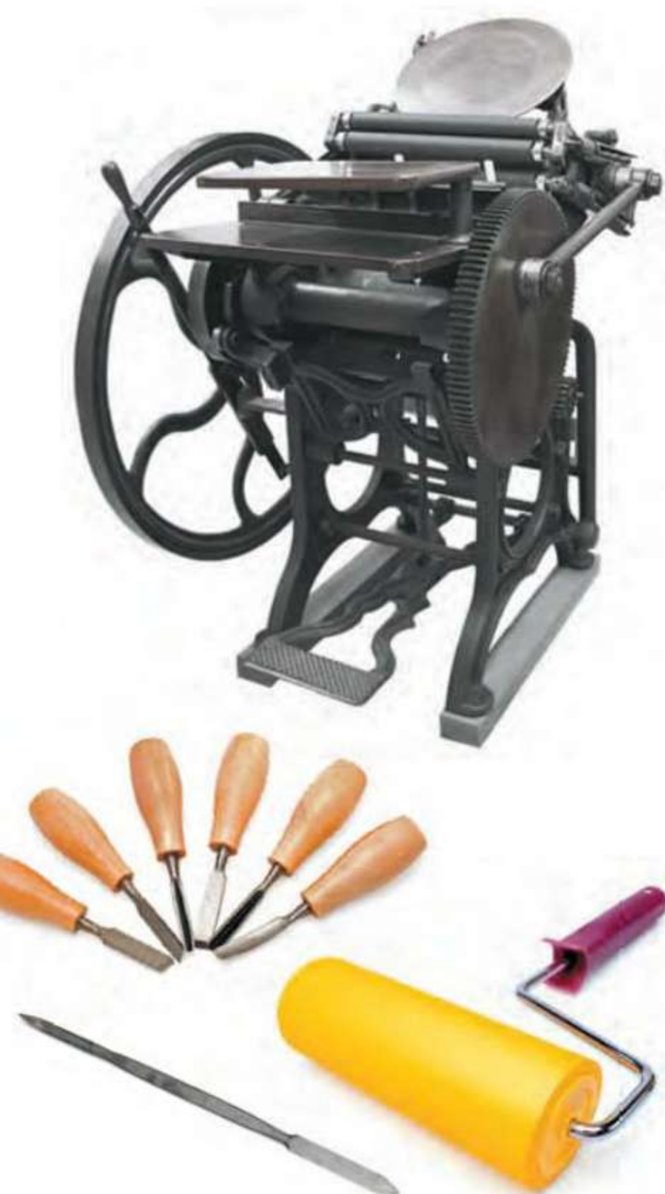
↑ 12. Narzędzia graficzne Tak wyglądają narzędzia w pracowni zawodowego grafika – igła grawerska i dłuta służące do sporządzania matrycy, wałek do nanoszenia farby i prasa dociskająca matrycę do odbitki.
