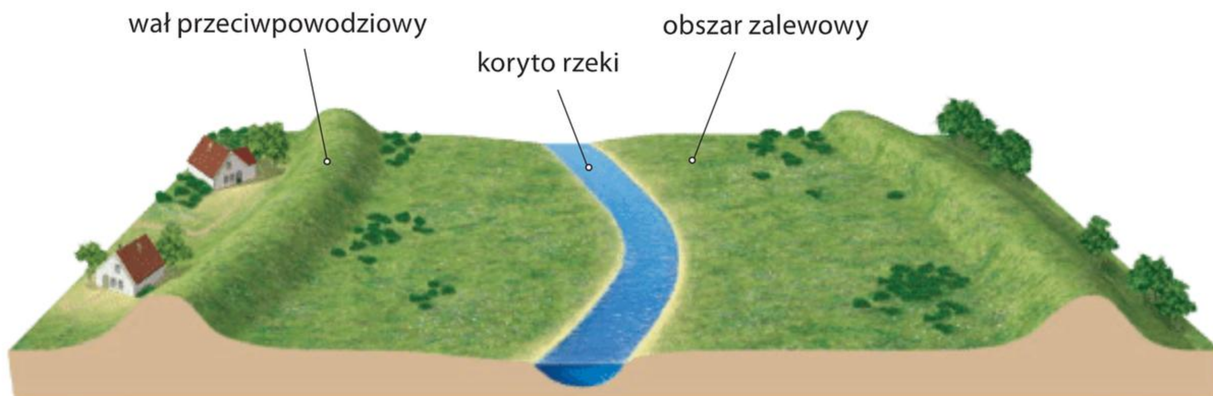
Schemat doliny rzecznej z wałami przeciwpowodziowymi.
