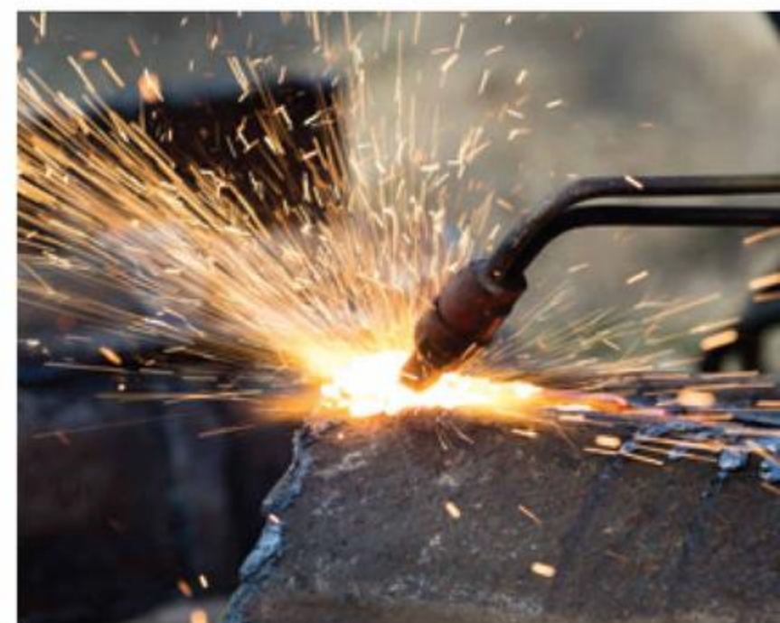
Fot. 81. Płomień palników acetylenowo-tlenowych osiąga temperaturę ok. 3000 °C.
