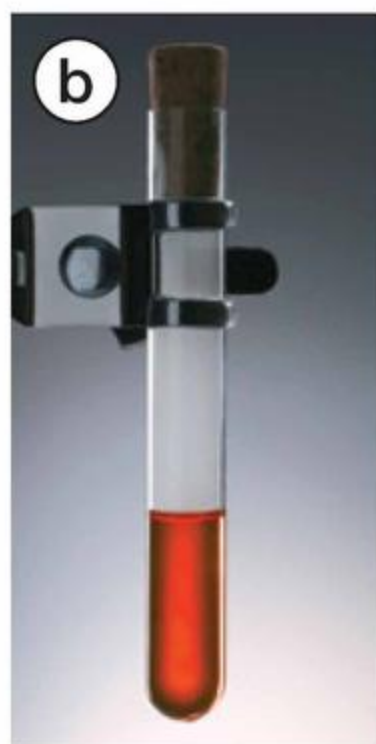
Fot. 21. Tlenek fosforu(V) powstaje w wyniku spalania fosforu czerwonego (a). Czerwona barwa wody z roztworem oranżu metylowego (b) świadczy o powstaniu kwasu fosforowego(V).
