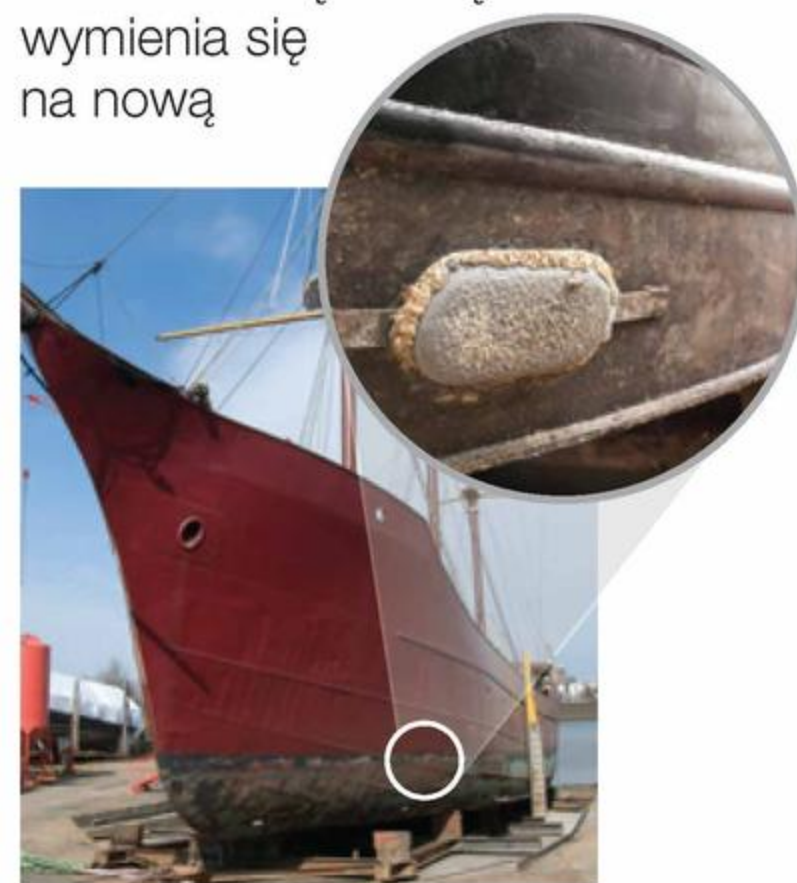
Fot. 41. Cynk ulega korozji szybciej niż żelazo.
