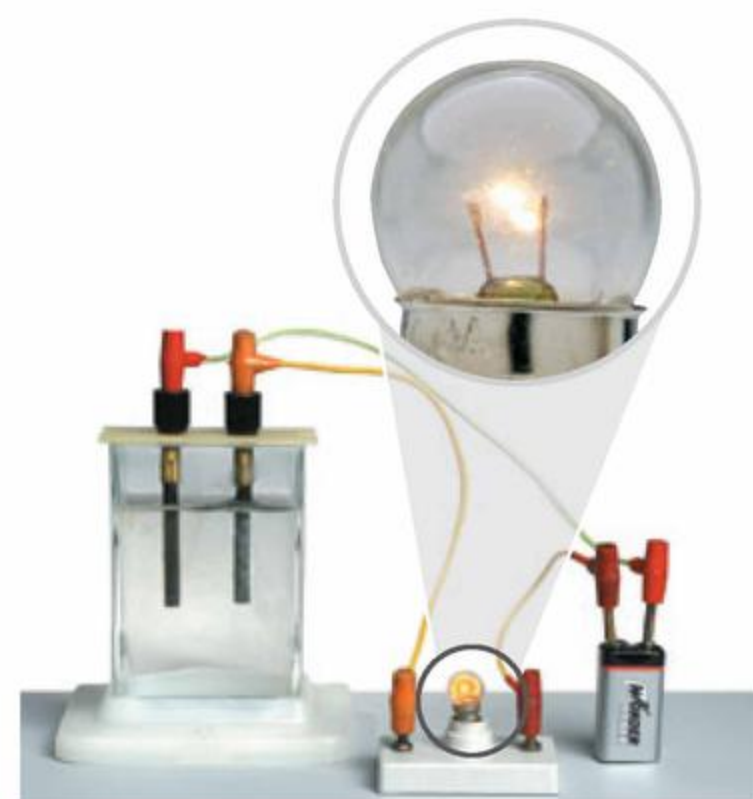
Fot. 23. O przewodzeniu prądu świadczy świecąca żarówka. Cząsteczki kwasów pod wpływem wody dysocjują na jony.
