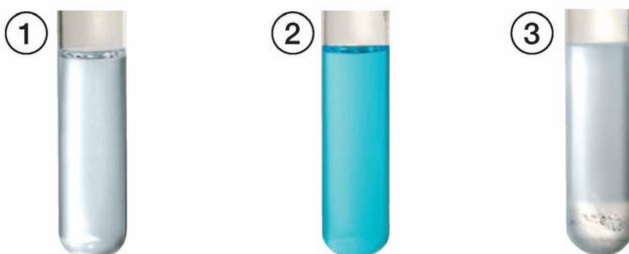
Fot. 34. Badanie rozpuszczalności soli w wodzie: ① azotanu(V) potasu \text{KNO}_3 ; ② siarczanu(VI) miedzi(II) \text{CuSO}_4 ; ③ siarczanu(VI) wapnia \text{CaSO}_4 .
