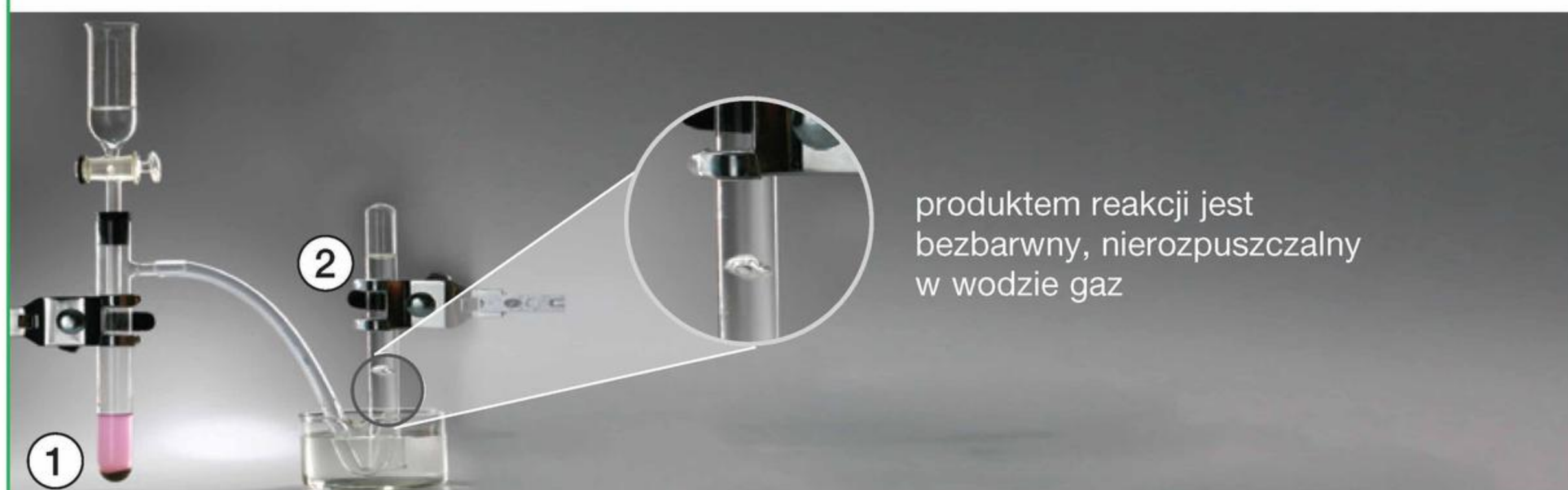
Fot. 82. Otrzymywanie etynu w reakcji karbidu z wodą.
