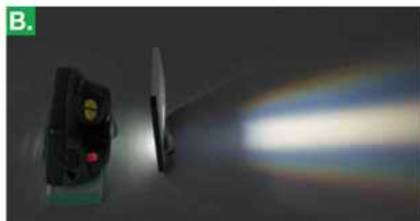
▲ Widmo światła białego po przejściu przez: pryzmat (A) i siatkę dyfrakcyjną (B)
