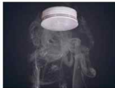
▲ Czujnik dymu wykorzystujący izotop promieniotwórczy
