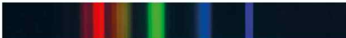
▲ Przykładowe widmo świetlówki kompaktowej
