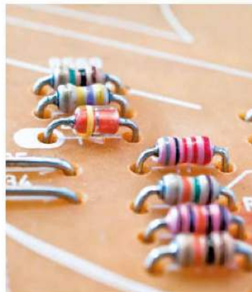
▲ W kolorowych paskach zakodowano opór oporników (tabela na s. 208)
