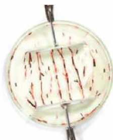
▲ Skrawki wstążki układają się wzdłuż linii pola elektrycznego
