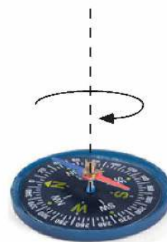
▲ Igła magnetyczna kompasu obraca się wokół osi
