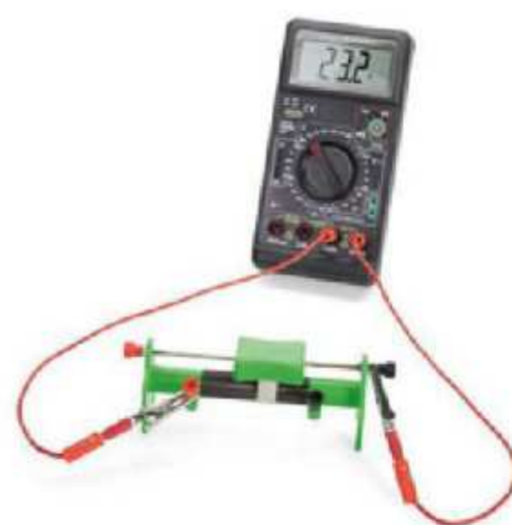
▲ Miernik uniwersalny włączony jako omomierz. Jako opornik został podłączony potencjometr
