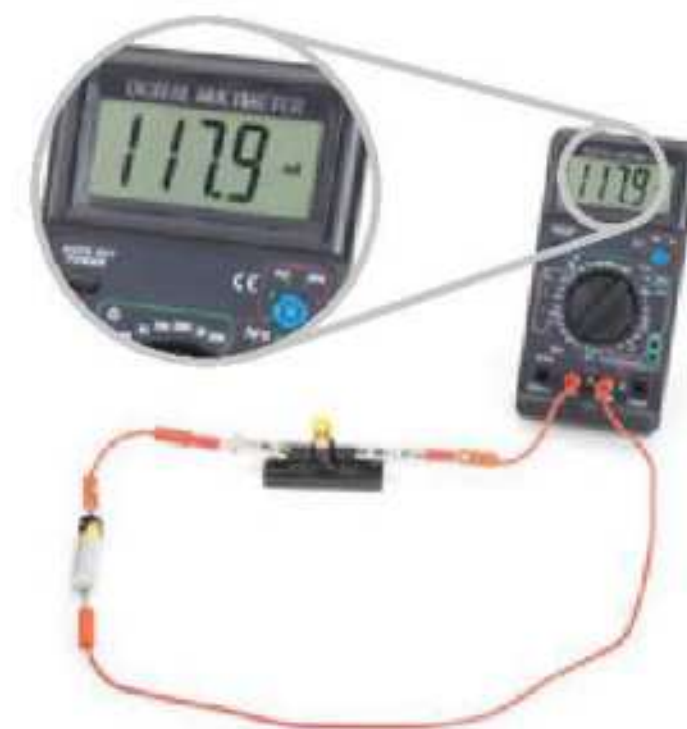
▲ Pomiar natężenia prądu
