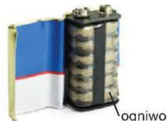
▲ Bateria 9 V składa się z sześciu połączonych ogniw
