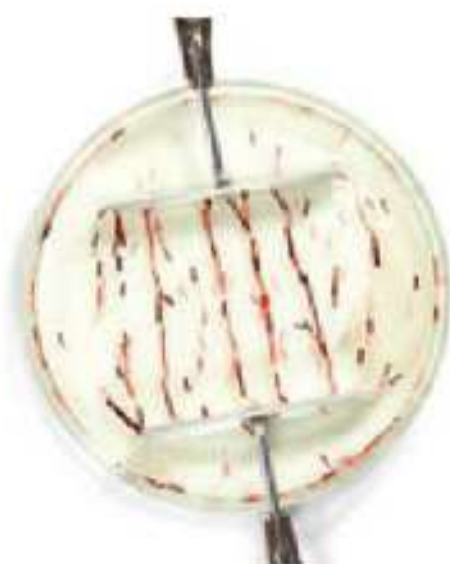
▲ Skrawki wstążki układają się wzdłuż linii pola elektrycznego
