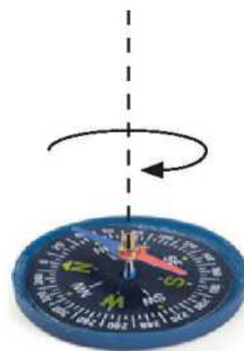
▲ Igła magnetyczna kompasu obraca się wokół osi
