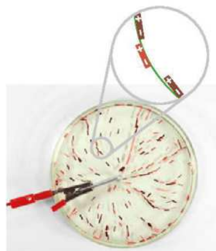
▲ Siły elektryczne powodują układanie się kawałków wstążki wzdłuż linii pola
