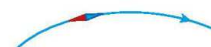
▲ Igła magnetyczna ustawia się stycznie do linii pola magnetycznego
