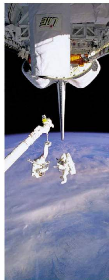
▲ Astronauci 240 km nad powierzchnią Ziemi testują plecak napędowy SAFER
