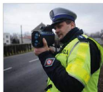
▲ Za pomocą radaru policjant dokonuje pomiaru prędkości chwilowej pojazdu
