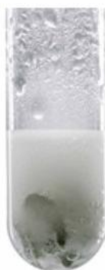
Fot. 31. Reakcja kwasu chlorowodorowego z magnezem (probówka 1.).
