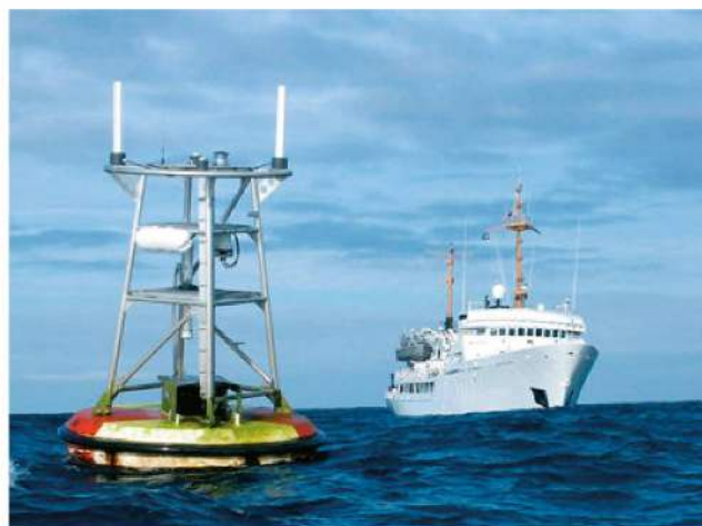
Najważniejszym źródłem informacji o ENSO jest sieć morskich boi pomiarowych na Pacyfiku. Rejestrują one między innymi zmiany temperatury wód powierzchniowych oraz kierunek przepływu wody.
