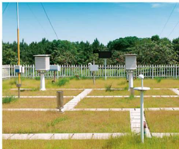
W stacjach meteorologicznych pomiary i obserwacje elementów pogody prowadzi się między innymi w ogródkach meteorologicznych.
