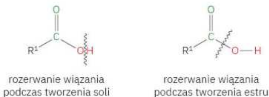
Rys. 24. Miejsce rozerwania wiązania w kwasach karboksylowych podczas tworzenia soli oraz estru.
