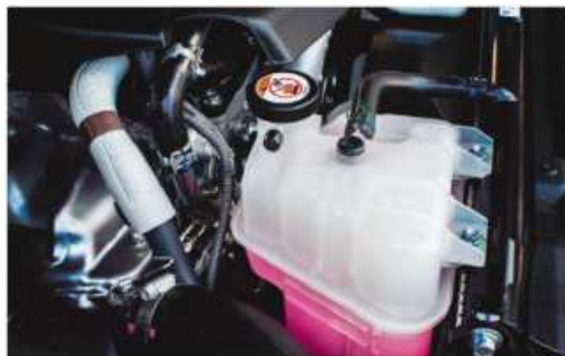
Rys. 8. Borygo to popularny płyn do chłodziw samochodowych, który jest pięćdziesięcioprocentowym roztworem glikolu z dodatkami antykorozyjnymi. Można go stosować do temperatury -35^{\circ}\text{C} . Różowy kolor wynika z obecności barwników.
