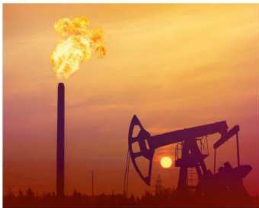
Rys. 24. Wydzielający się gaz ziemny towarzyszący wydobyciu ropy naftowej jest spalany, ponieważ jego izolowanie i przechowywanie jest procesem nieekonomicznym.
