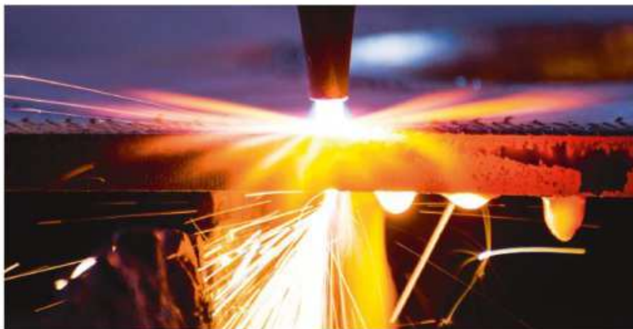
Rys. 13. Cięcie metali za pomocą palnika acetylenowego.
