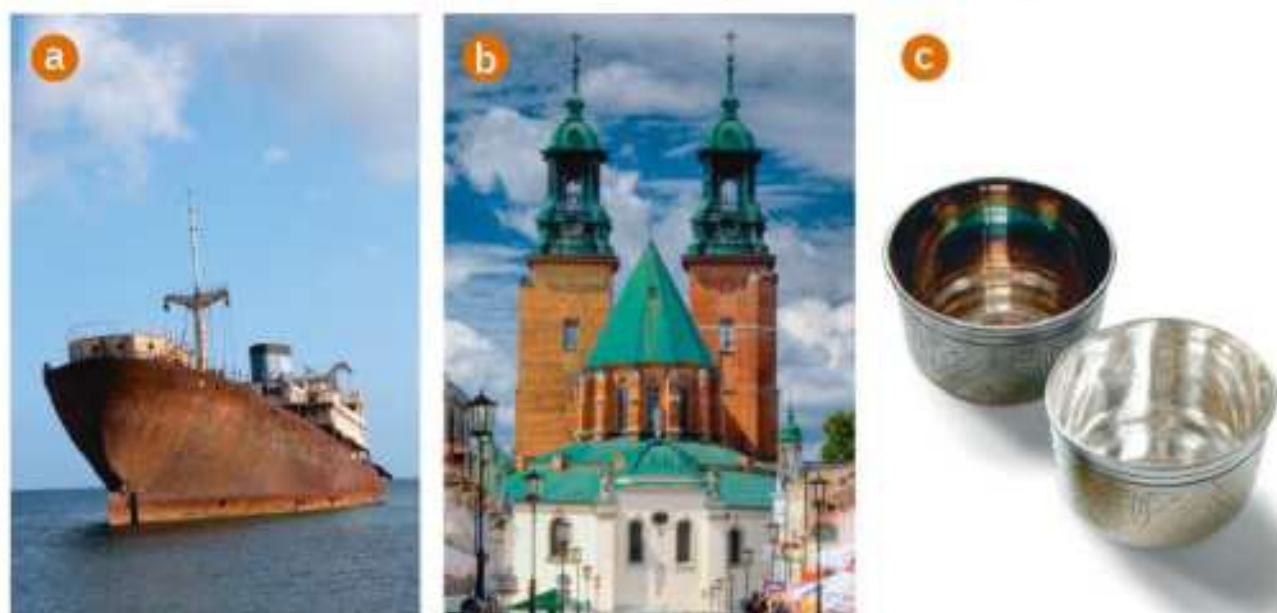
Rys. 3.2. Korozja metali: a) zardzewiały stalowy kadłub statku; b) dachy katedry w Gnieźnie pokryte patyną; c) naczynie srebrne przed oczyszczeniem i po oczyszczeniu z nalotu produktów korozji.
