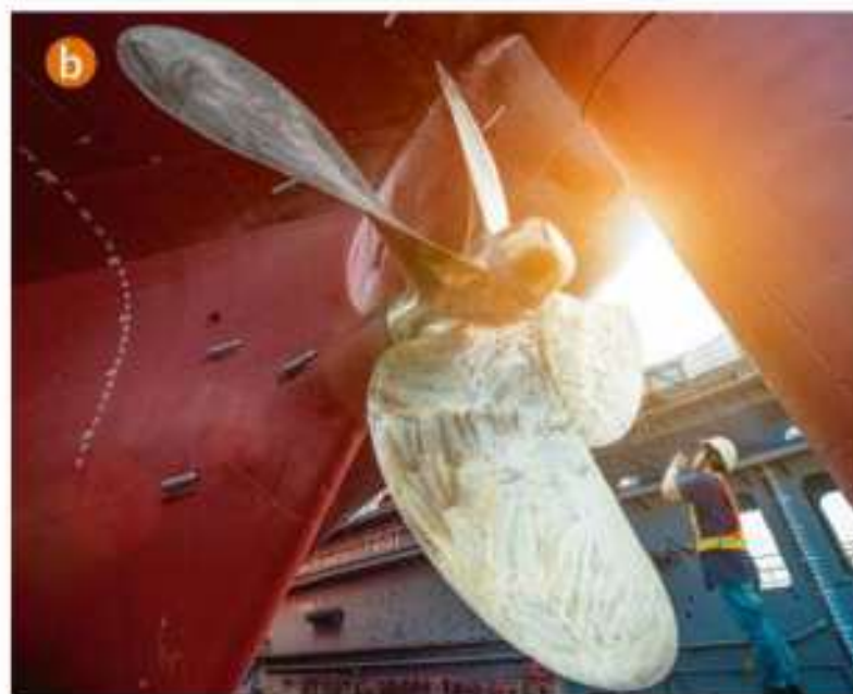
Rys. 3.6. Ochrona protektorowa: a) mechanizm działania ochrony protektorowej; b) bloki protektora przymocowane do stalowego kadłuba statku.
