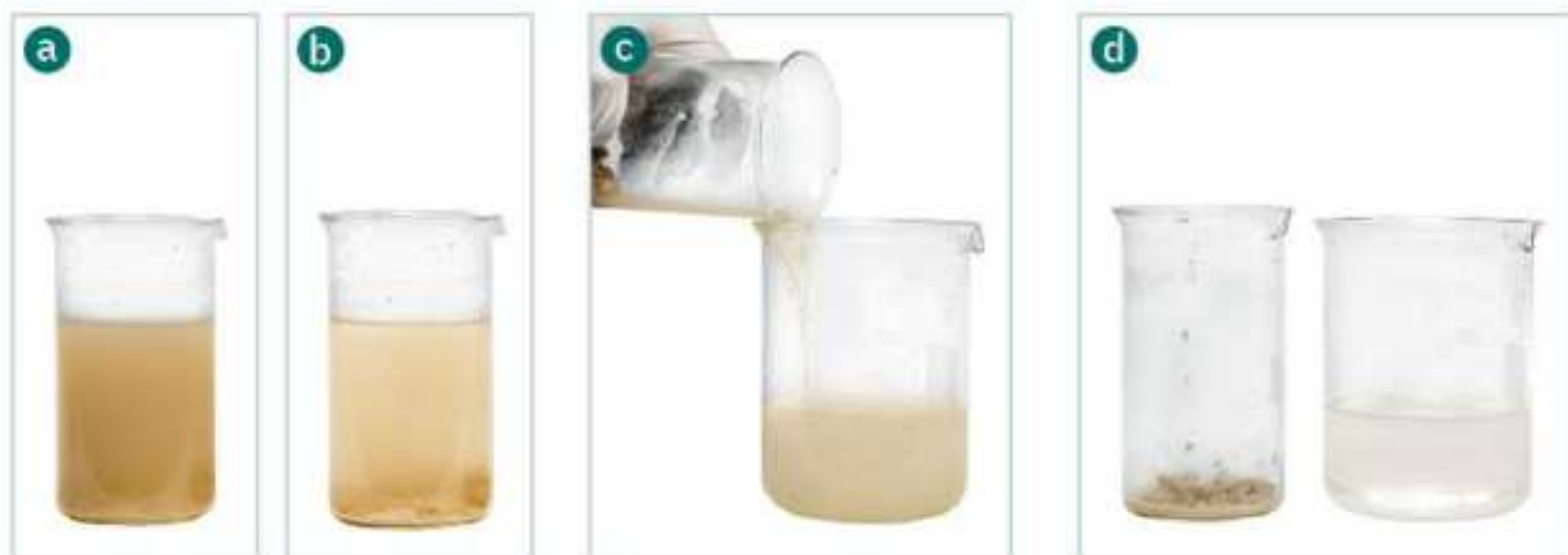
Rys. 2.15. Kolejne etapy sedymentacji zawiesiny (a i b) i jej dekantacja (c i d).
