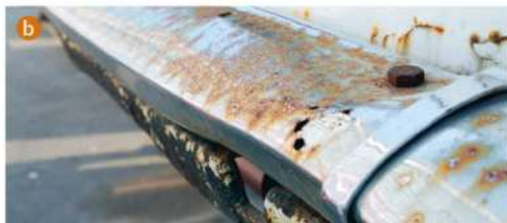
Rys. 3.4. Skutki uszkodzenia powłoki ochronnej wykonanej z metalu mniej reaktywnego niż żelazo: a) zardzewiała puszka wykonana z blachy stalowej pokrytej cyną; b) zardzewiały zderzak samochodu pokryty powłoką z niklu i chromu.
