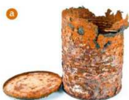
Rys. 3.4. Skutki uszkodzenia powłoki ochronnej wykonanej z metalu mniej reaktywnego niż żelazo: a) zardzewiała puszka wykonana z blachy stalowej pokrytej cyną; b) zardzewiały zderzak samochodu pokryty powłoką z niklu i chromu.
