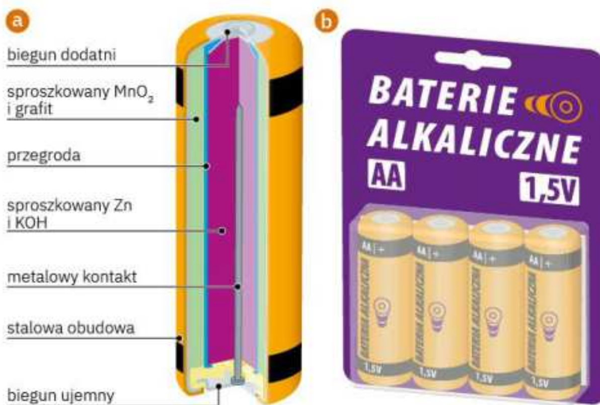
Rys. 1.5. Baterie alkaliczne: a) schemat budowy; b) opakowanie baterii alkalicznych AA 1,5 V, tzw. paluszków.
