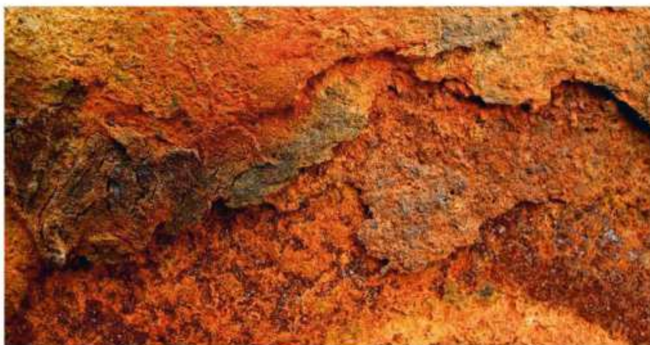
Rys. 5.3. Rdza – warstwa produktów utleniania żelaza i jego stopów w wodzie, wilgotnej atmosferze lub gruncie, zawierająca głównie tlenki i wodorotlenki żelaza.
