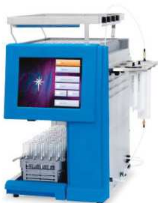
Rys. 2.8. Zautomatyzowany zestaw do chromatografii kolumnowej. Rozpuszczalnik jest tłoczony do kolumny za pomocą pomp (pod zwiększonym ciśnieniem). Rejestrator badający wypływającą ciecz z kolumny informuje o pojawianiu się kolejnych składników mieszaniny (frakcji), które są zbierane do osobnych naczyń w tzw. kolektorze frakcji.
