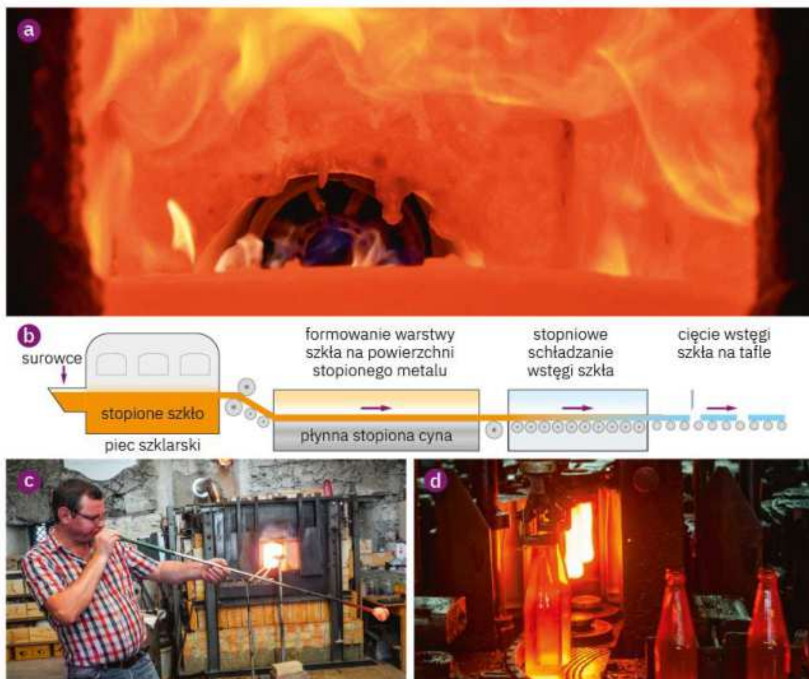
Rys. 1.6. Produkcja i formowanie szkła: a) wnętrze pieca szklarskiego; b) schemat wytwarzania szkła płaskiego metodą float; c) ręczne dmuchanie szkła; d) automatyczna linia do formowania butelek.
