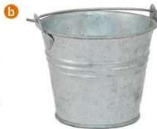
Rys. 3.5. Działanie powłoki ochronnej wykonanej z metalu bardziej reaktywnego niż żelazo: a) mechanizm działania ochronnego powłoki cynkowej; b) stare wiadro z ocynkowanej blachy stalowej nie wykazuje oznak korozji.
