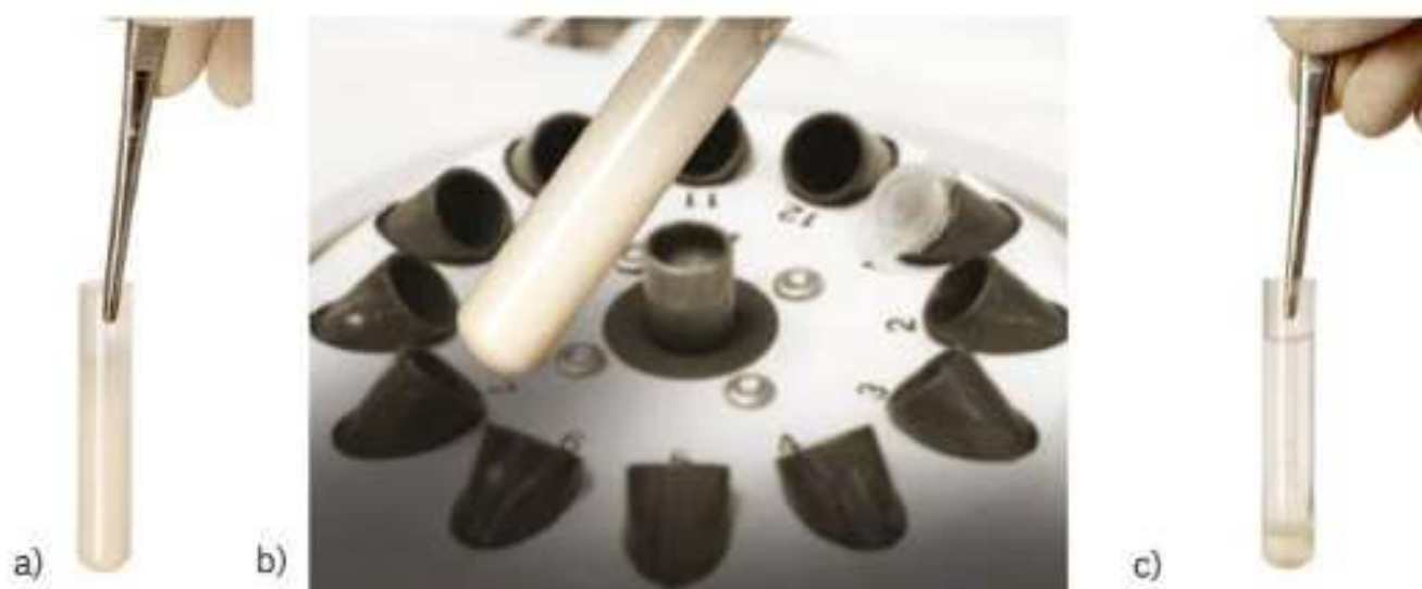
Rysunek 4. Zawiesina przed odwirowaniem (a), wirówka (b), zawiesina po odwirowaniu (c).
