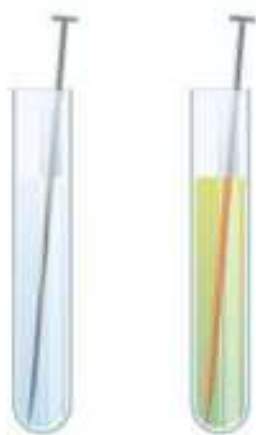
Rysunek 2. Niebieska barwa jonów \text{Cu}^{2+} zanika, ponieważ jony te ulegają redukcji, osadzając się na gwoździu. Na barwę roztworu zaczynają wpływać jony \text{Fe}^{2+} , które pojawiają się w roztworze po utlenieniu metalicznego żelaza.
