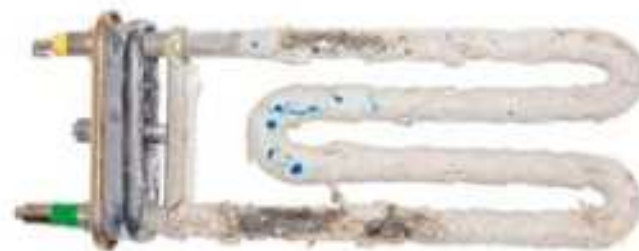
Rysunek 5. Kamień kotłowy na grzałce elektrycznej.
