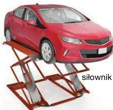
Rys. 6.9. Podnośnik hydrauliczny pozwala podnieść samochód w warsztacie
