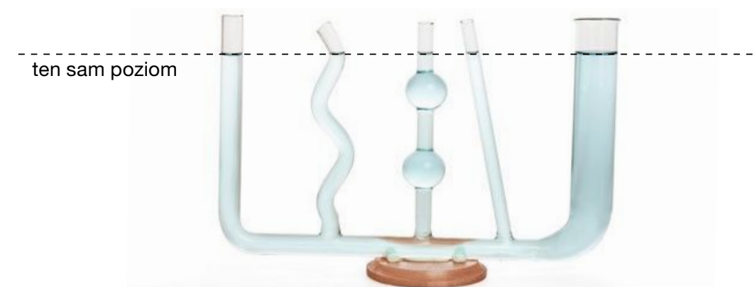
Rys. 6.12. Prawo naczyń połączonych obowiązuje dla wszystkich naczyń niezależnie od ich kształtu i szerokości
