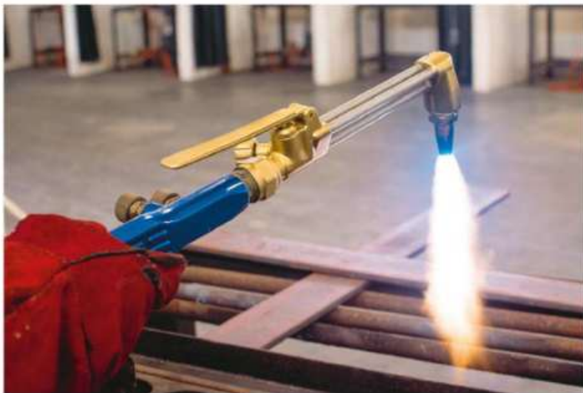
Rys. 14.3. Etyn (acetylen) jest stosowany w palnikach acetylenowo-tlenowych do spawania oraz cięcia metali i ich stopów.
