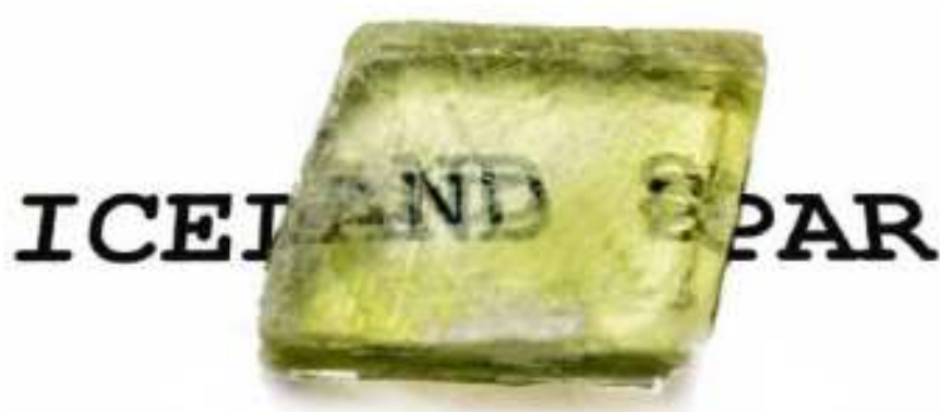
Rys. 3.6. Kryształy kalcytu są dwójłomne, dzięki czemu wytwarza się z nich przyrządy optyczne (polaryzatory, mikroskopy polaryzacyjne).
