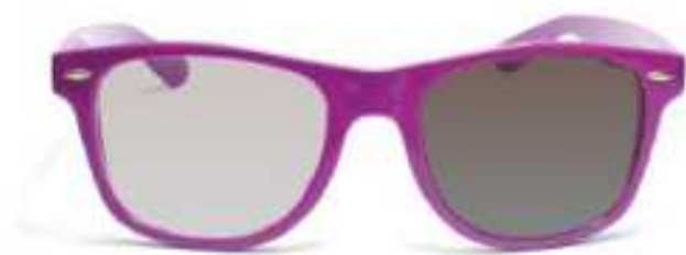
Rys. 4.6. Okulary fotochromowe. Na działanie promieniowania ultrafioletowego była wystawiona tylko jedna soczewka.
