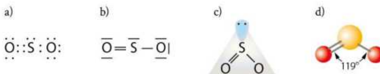
Rys. 3.1. Kształt cząsteczki tlenku siarki(IV) SO_2 : a) kropkowy wzór elektronowy, b) kreskowy wzór elektronowy, c) trygonalne rozmieszczenie par elektronowych, d) model cząsteczki.
