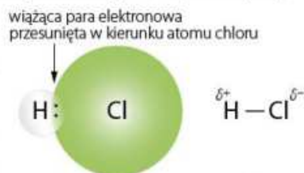
Rys. 2.3. Spolaryzowane wiązanie kowalencyjne w cząsteczce chlorowodoru HCl.
