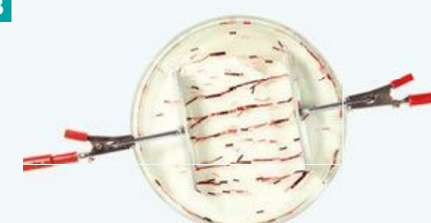
▲ Linie pola jednorodnego pomiędzy dwiema przeciwnie naładowanymi płytkami
