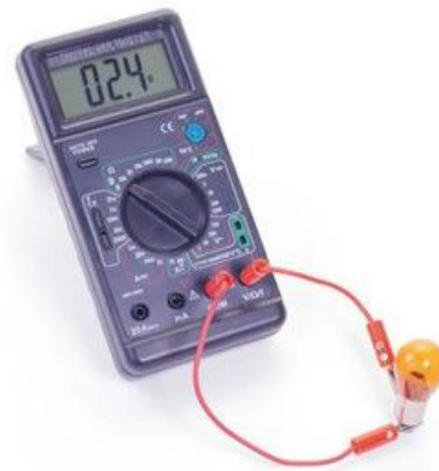
▲ Sprawdzanie żarówki za pomocą omomierza
