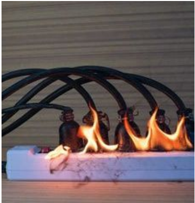
▲ Zbyt obciążony rozgałęźnik zapala się
