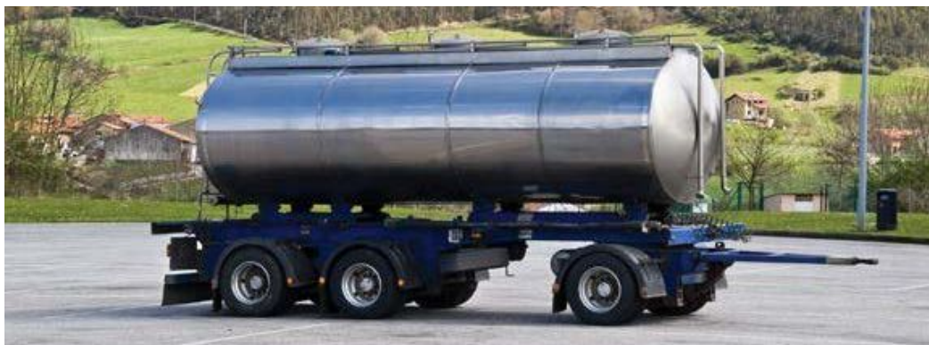
Fot. 59. Dzięki pasywacji w cysternach wykonanych z glinu można przewozić roztwory silnych utleniaczy, takich jak kwas azotowy(V) \text{HNO}_3 .
