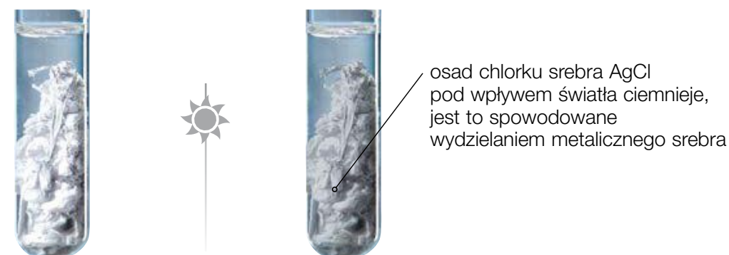
Fot. 62. Energia świetlna powoduje rozkład chlorku srebra AgCl.
