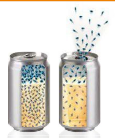
Rys. 11. Ciśnienie ma wpływ na rozpuszczalność gazów w rozpuszczalniku.
