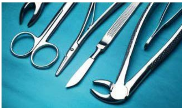
Fot. 60. Oksydowane, czyli pokryte cienką warstwą tlenku, stalowe narzędzia medyczne w mniejszym stopniu odbijają światło. Zapobiega to zmęczeniu wzroku lekarzy podczas operacji.
