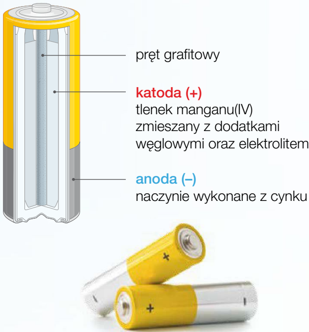
Baterie cynkowo-węglowe coraz częściej zastępowane są przez baterie alkaliczne.
