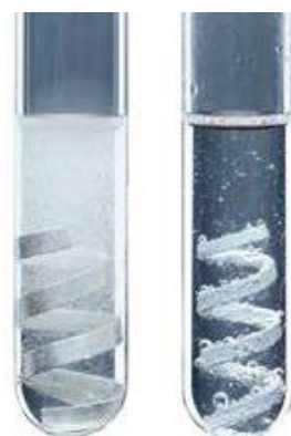
Fot. 46. Magnez i cynk wypierają wodór z kwasu chlorowodorowego.
