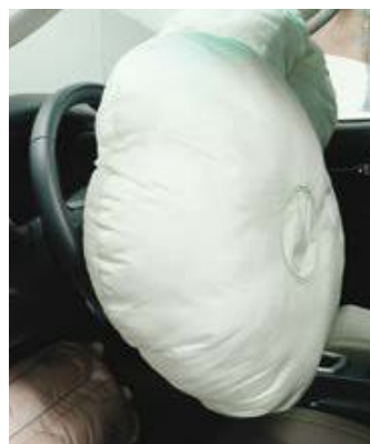
Fot. 68. Poduszkę powietrzną wypełnia gazowy azot, który powstaje w reakcji chemicznej trwającej ok. 0,025 s.
