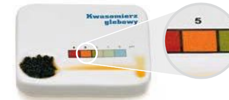
Fot. 39. Badanie odczynu gleby kwasomierzem Helliga.
