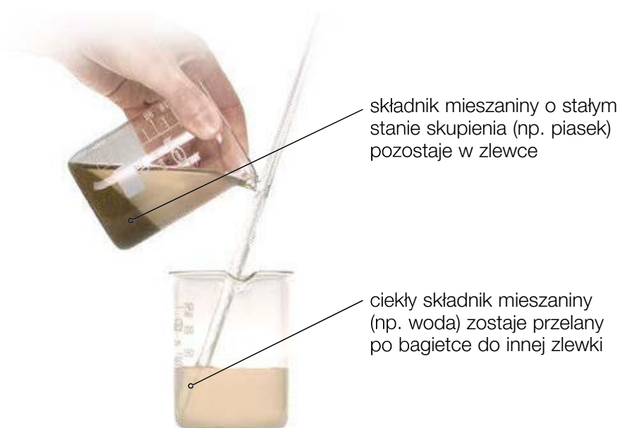
Fot. 14. Rozdzielanie mieszanki – wody i piasku – na składniki poprzez dekantację.
