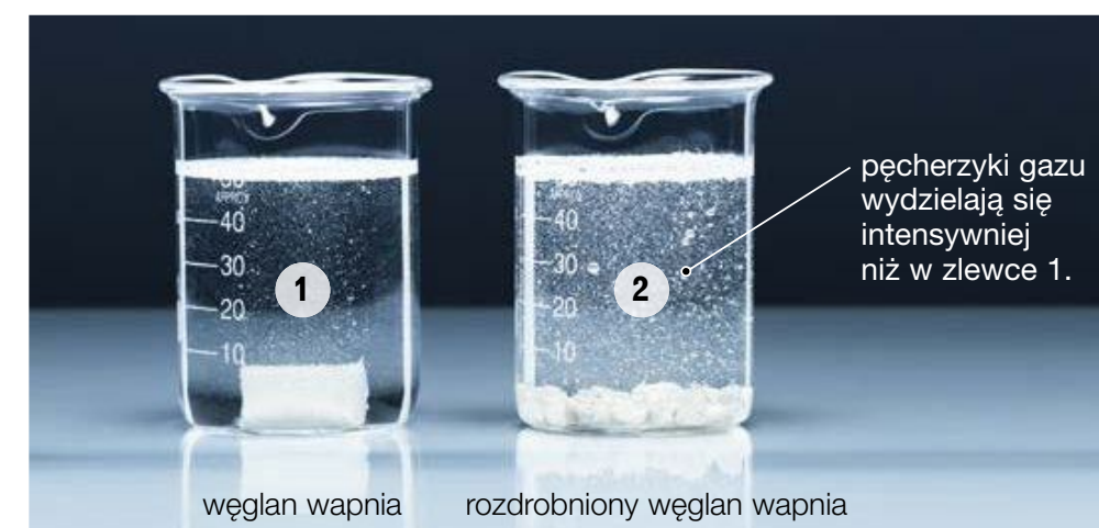
Fot. 69. Reakcja kwasu chlorowodorowego z węglanem wapnia: nierozdrobnionym (zlewka 1.) i rozdrobnionym (zlewka 2.).
