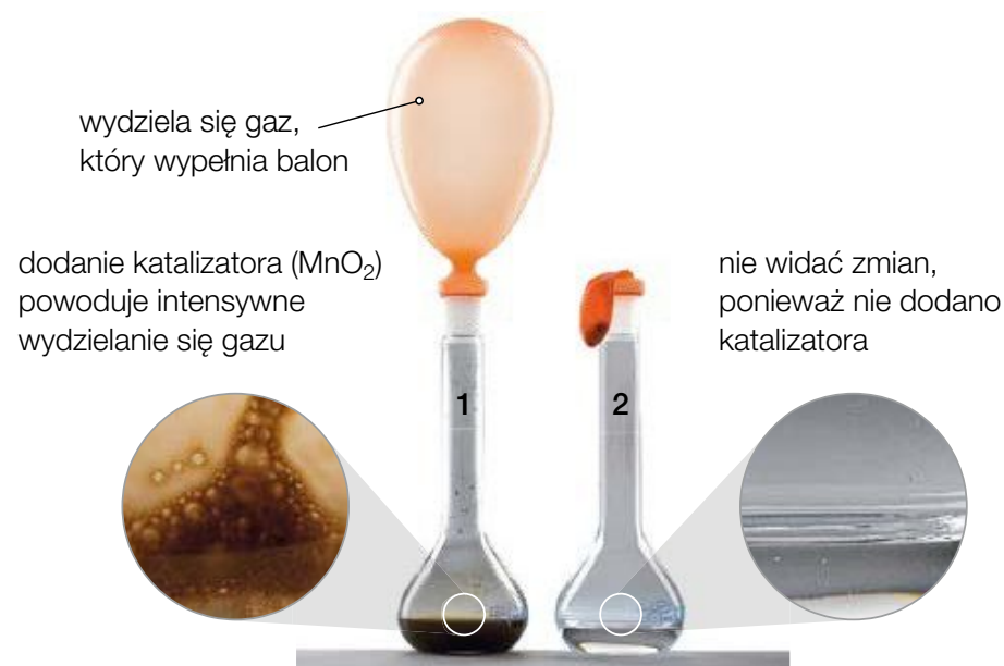
Fot. 72. Dodanie tlenku manganu(IV) do wody utlenionej (nadtlenku wodoru) powoduje rozkład nadtlenku wodoru i wydzielanie się pęcherzyków gazu.
