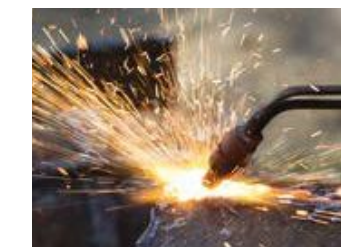
Fot. 97. W palnikach acetylenowo-tlenowych zachodzi reakcja spalania całkowitego etynu.
