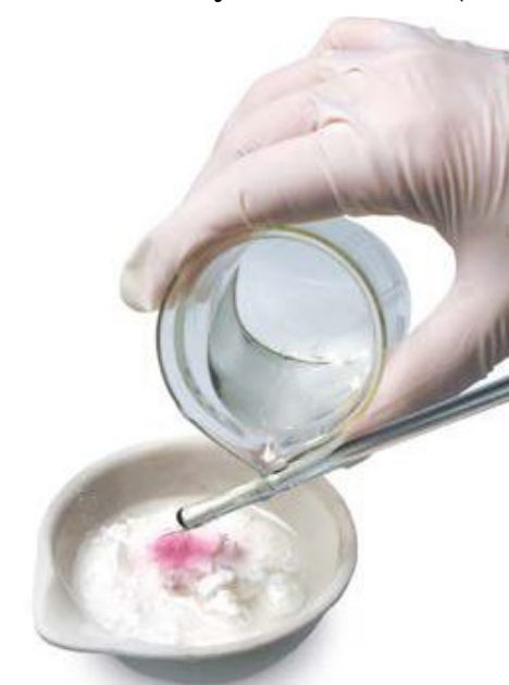
Fot. 72. Gaszenie wapna palonego.
