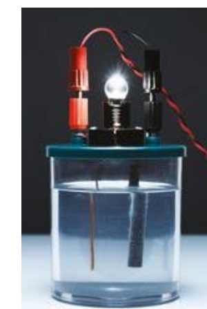
Fot. 66. Świecąca żarówka świadczy o tym, że roztwory soli przewodzą prąd elektryczny.
