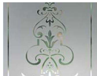
Fot. 38. Szkło matowieje pod wpływem fluorowodoru.
