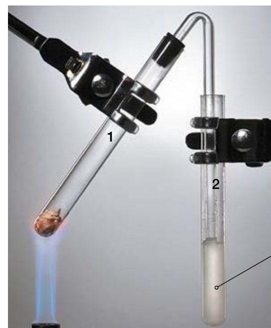
Fot. 71. Termiczny rozkład wapieni i reakcja jednego z produktów z nasyconym roztworem wodorotlenku wapnia.
