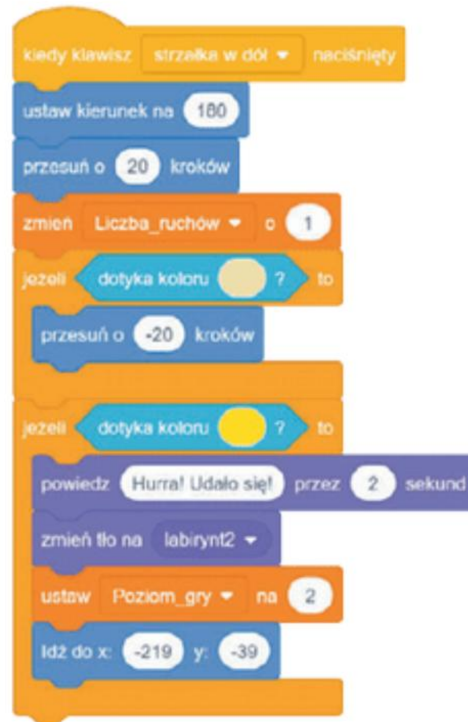
Rys. 11. Fragment skryptu dla klawisza ze strzałką w dół z blokami określającymi zmianę wartości zmiennych
