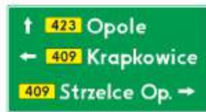
E-2a – Drogowskaz tablicowy umieszczony obok jezdni
