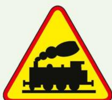
Przejazd kolejowy bez zapor
