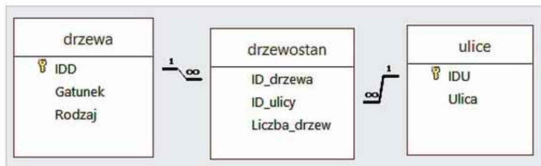
Rys. 17.9. Relacje między tabelami utworzone w programie Access
