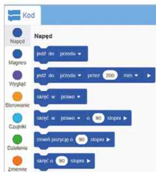
Rys. 19.21. Panel Kod zawierający instrukcje sterujące robotem
