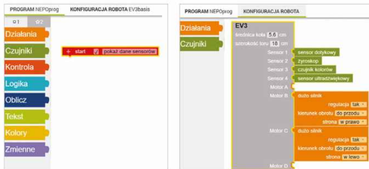
Rys. 19.10. Obszar roboczy Open Roberta Lab i konfiguracja robota EV3
