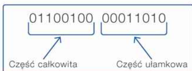
Rys. 5.3. Reprezentacja stałoprzecinkowa liczby 100,1 w systemie dwójkowym, jeśli na część całkowitą i ułamkową przeznaczono po 1 bajcie
