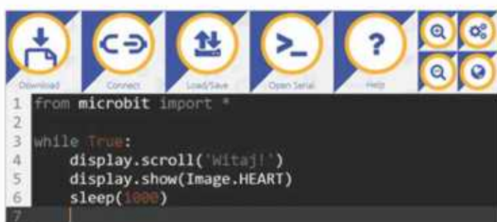
Rys. 19.8. Programowanie płytki micro:bit w języku MicroPython
