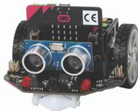
Rys. 19.7. Przykład robota micro:Maqueen, wykonanego z użyciem mikrokontrolera micro:bit
