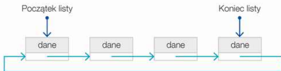
Rys. 3.2. Przykład listy jednokierunkowej cyklicznej złożonej z czterech elementów
