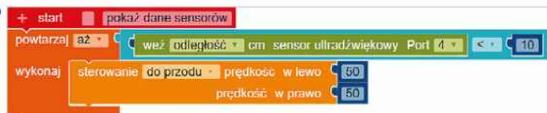
Rys. 19.13. Kod źródłowy programu Zatrzymanie przed przeszkodą
