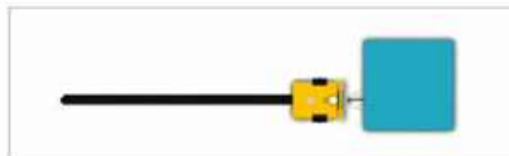
Rys. 19.14. Efekt symulacji działania robota w programie Zatrzymanie przed przeszkodą
