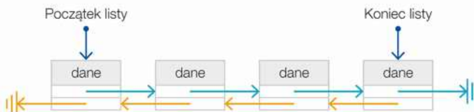
Rys. 3.3. Przykład listy dwukierunkowej złożonej z czterech elementów
