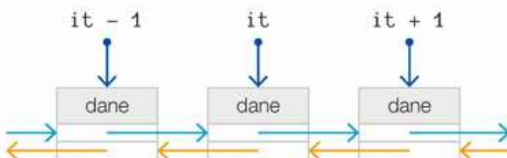
Rys. 3.8. Fragment listy z wartościami iteratorów it , it - 1 oraz it + 1
