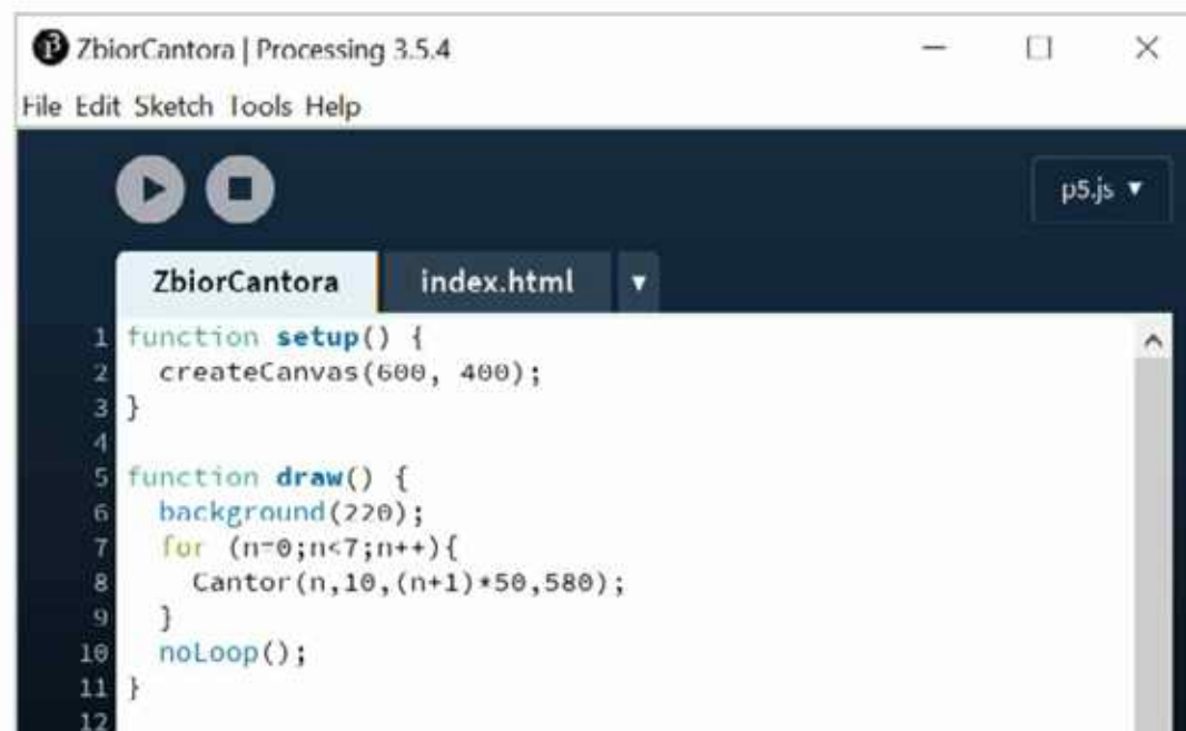
Rys. 10.5. Okno środowiska Processing z fragmentem skryptu rysującego zbiory Cantora stopni od 0 do 6
