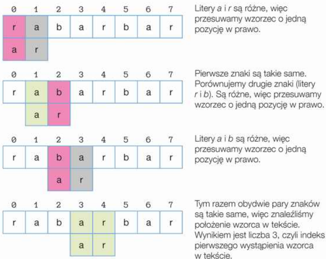
Rys. 11.1. Naiwne wyszukiwanie wzorca w tekście
