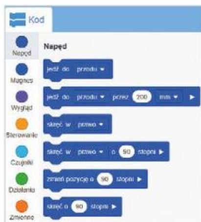
Rys. 11.21. Panel Kod zawierający instrukcje sterujące robotem
