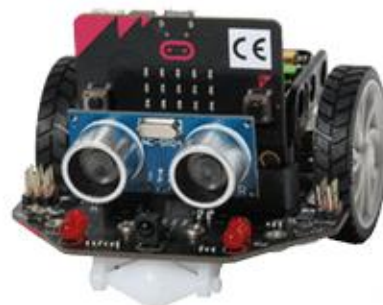
Rys. 11.7. Przykład robota micro:Maqueen, wykonanego z użyciem mikrokontrolera micro:bit
