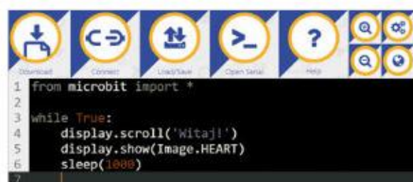
Rys. 11.8. Programowanie płytki micro:bit w języku MicroPython
