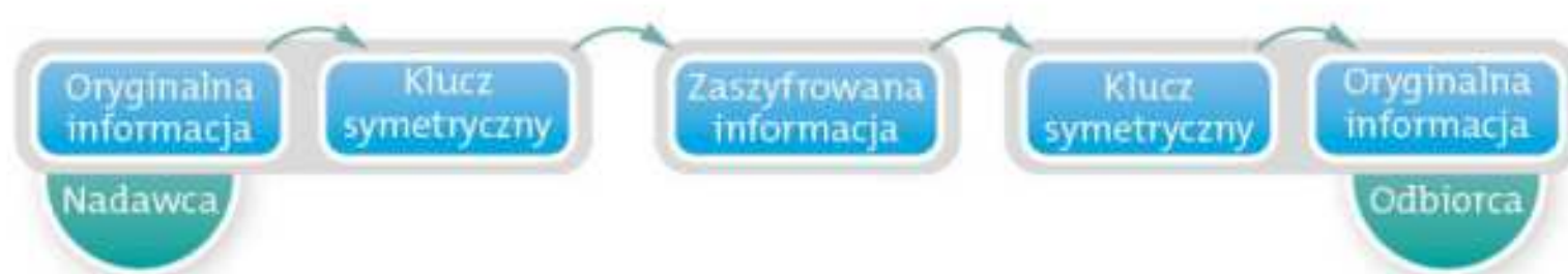
Rys. 15.1. Schemat szyfrowania symetrycznego
