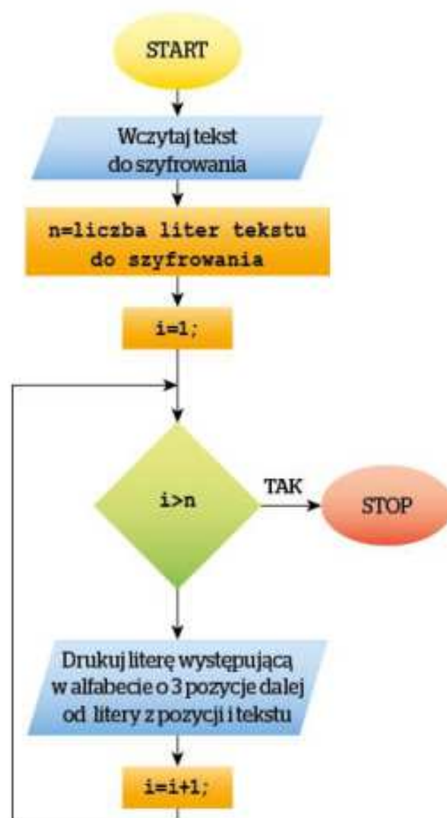
Rys. 14.3. Algorytm opisujący metodę szyfrowania szyfrem Cezara
