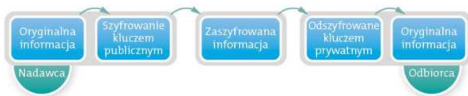
Rys. 15.2. Schemat szyfrowania asymetrycznego
