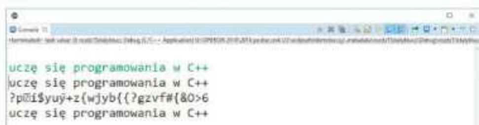
Rys. 15.4. Wynik działania przykładowego programu szyfrującego i deszyfrującego ze stałym kluczem
