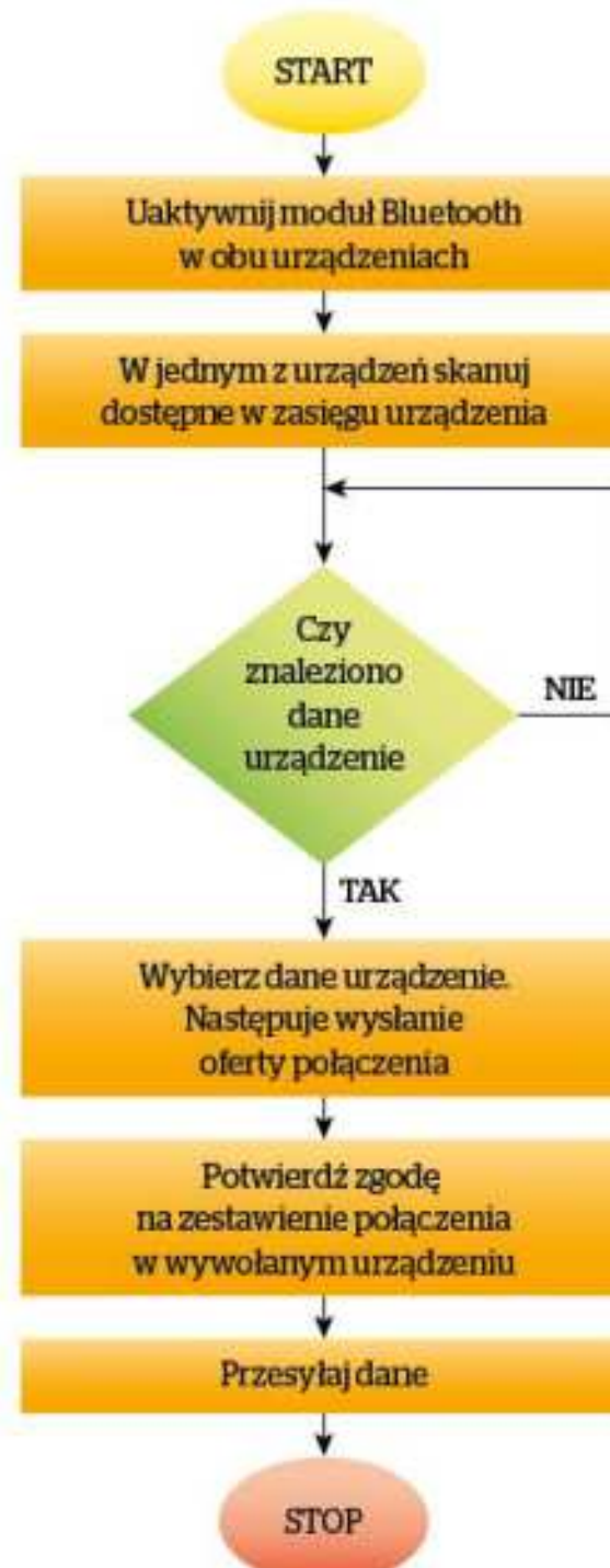
Rys. 28.2. Proces zestawienia połączenia P2P urządzeń z Bluetooth
