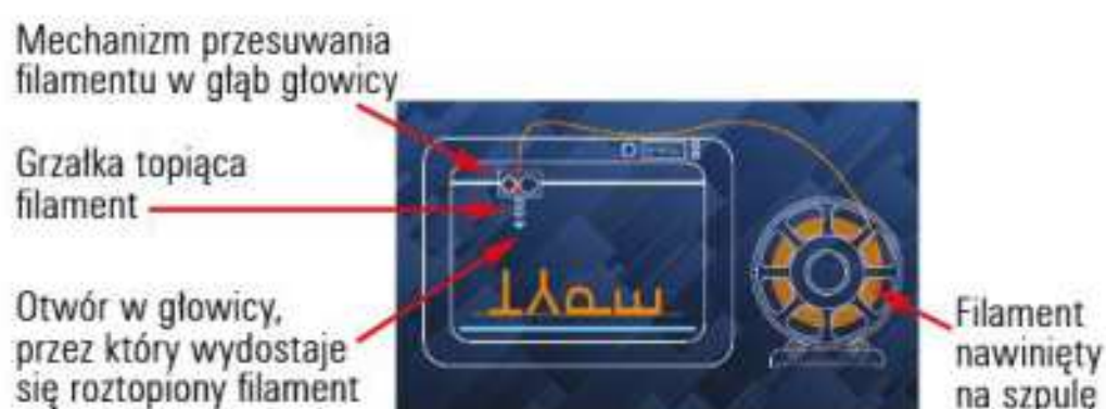
Rys. 17.3. Filament i głowica drukarki 3D
