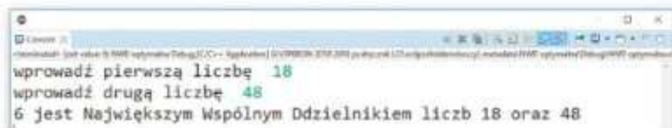
Rys. 11.6. Komunikaty wyświetlane przez przykładowy program obliczający NWD metodą zoptymalizowaną Euklidesa
