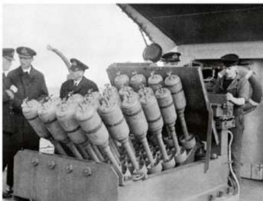
Hedgehog, 24-lufowy rakietowy miotacz bomb głębinowych do zwalczania okrętów podwodnych, zamontowany na pokładzie brytyjskiego niszczyciela
