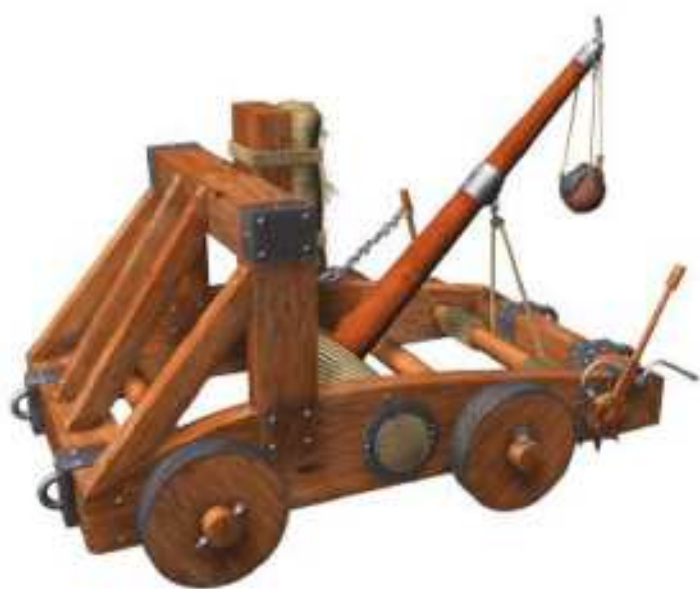
Jedna z rzymskich machin miotających pociski – onager, współczesna rekonstrukcja
