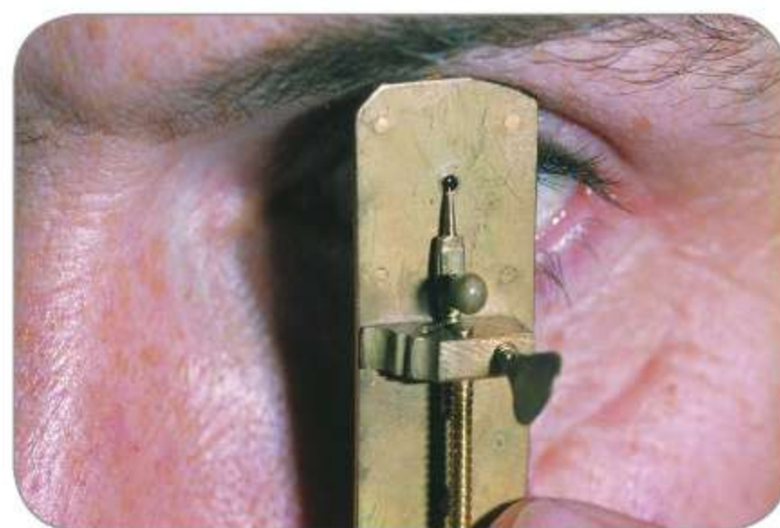
Obserwacje przez mikroskop van Leeuwenhoeka. Preparat umieszczano na czubku igły.
