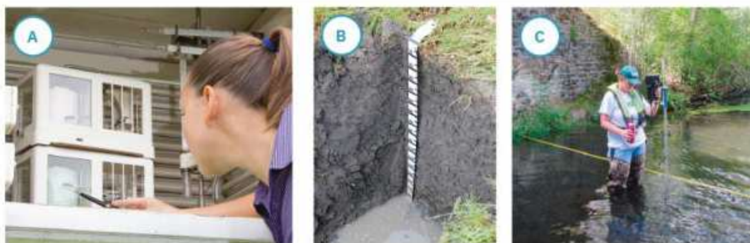
Fot. V.1.1. Badania terenowe w geografii mogą być prowadzone przy pomocy metod obserwacji i pomiarów, np. odczytu danych w ogródku meteorologicznym (A), analizy odkrywki glebowej (B) i pomiaru przepływu w cieku (C).
