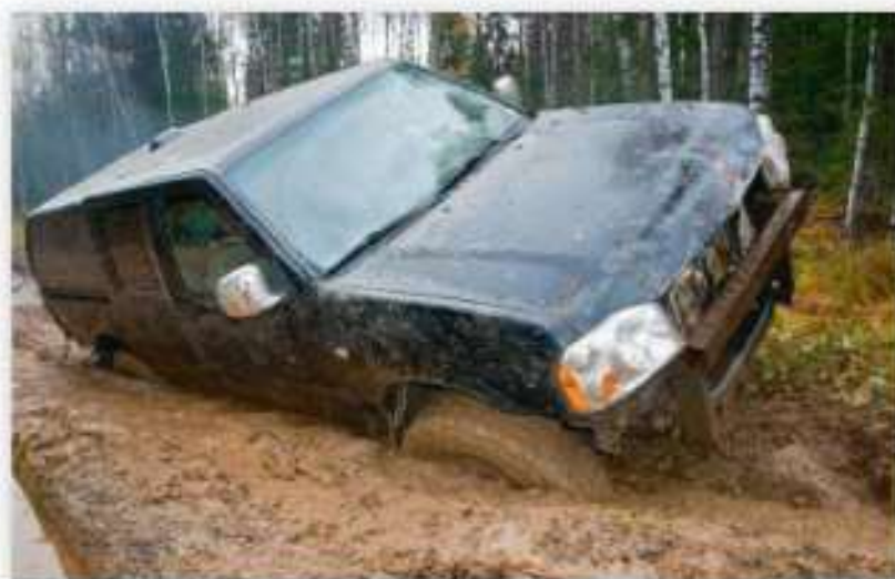
Ryc. 3.6. Rozmarzanie wieloletniej zmarzliny znacznie utrudnia komunikację lądową. Twardy, zamrożony wcześniej grunt staje się grząski, zatem nie jest możliwy przejazd samochodów, rozmarznięty grunt nie utrzymuje domów i podpór gazociągów i powoduje ich zapadanie się.
