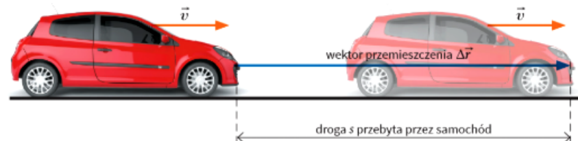
Ryc. 2.7. Prędkość i przemieszczenie to wielkości wektorowe, droga to wielkość skalarna
