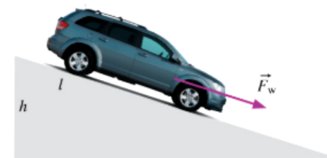
Ryc. 12.5. Wypadkowa siła działająca na zjeżdżający z pochyłości samochód jest skierowana w kierunku ruchu, czyli równoległe do równi
