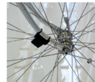
Ryc. 2.2. Koło rowerowe z systemem do pomiaru prędkości
