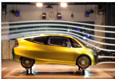
Ryc. 8.3. Gdy samochód jedzie, to powietrze musi go w jakiś sposób ominąć. W tunelu aerodynamicznym służącym do badań przepływu powietrza wokół poruszającego się samochodu to powietrze się porusza. Znaczenie ma ruch względny pojazdu i powietrza
