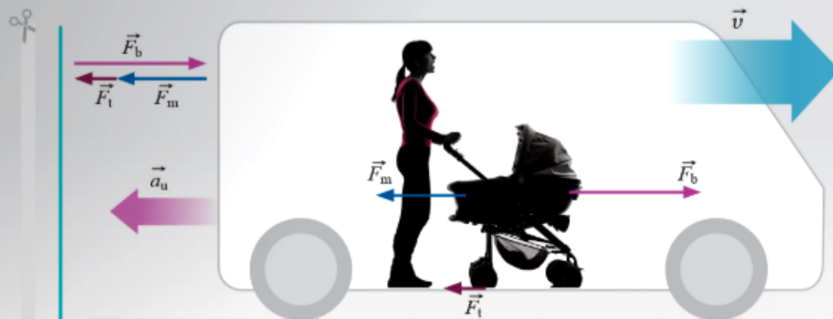
Siły działające na wózek znajdujący się w nieinercyjnym układzie odniesienia
