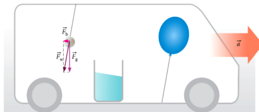
Ryc. 3. W przyspieszającym autobusie wszystkie ciała zachowują się tak, jakby kierunek pionu wyznaczała wypadkowa sił grawitacji oraz bezwładności
