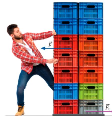
Ryc. 12.1. Aby przesuwać przedmioty ze stałą prędkością po linii prostej, musimy zrównoważyć siłę tarcia
