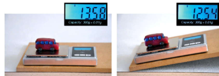
Ryc. 12.7. Do pomiaru siły nacisku może służyć waga kuchenna lub łazienkowa. Aby uzyskać wynik w niutonach, trzeba wskazania wagi w kilogramach pomnożyć przez przyspieszenie ziemskie g
