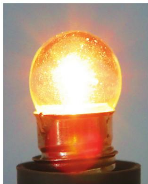
4.22 Światlny i cieplny skutek przepływu prądu. Żarówka świeci i wydziela się ciepło
