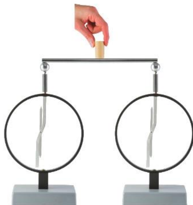
4.1 Naelektryzowane różnoimiennie elektroskopy połączone metalowym łącznikiem rozładowują się
