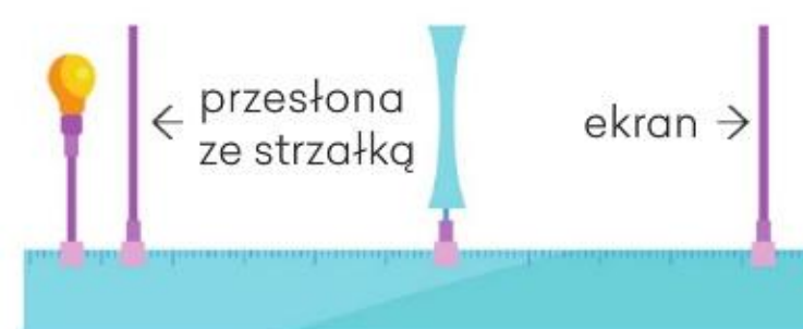
6.57 Ława optyczna z soczewką rozpraszającą
