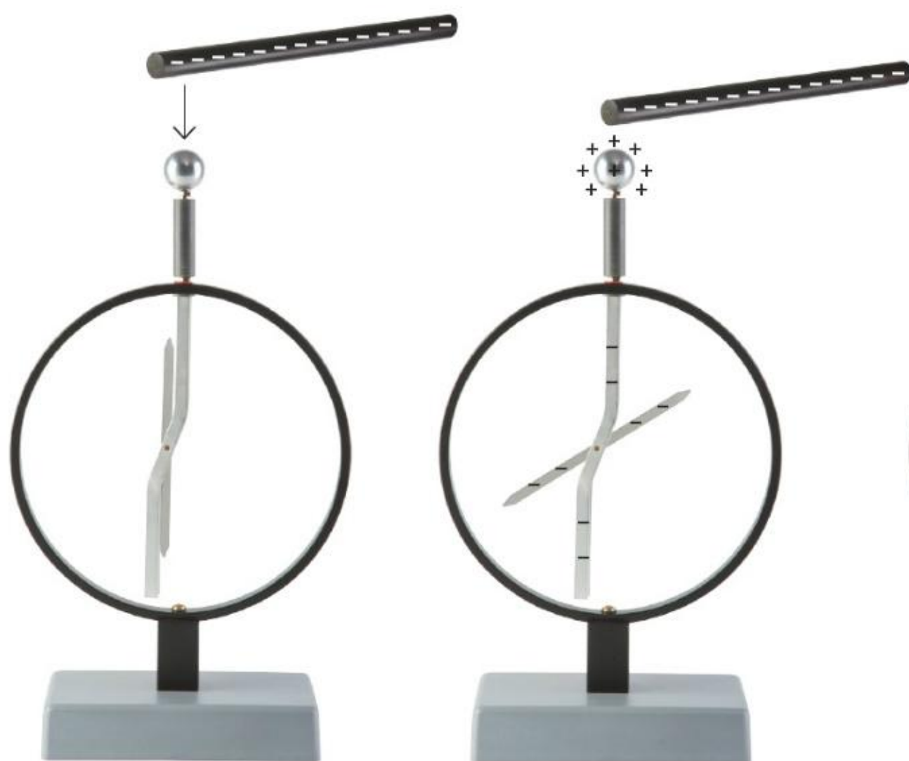
3.27 Rozdział ładunków w elektroskopie pod wpływem ciała naelektryzowanego ujemnie
