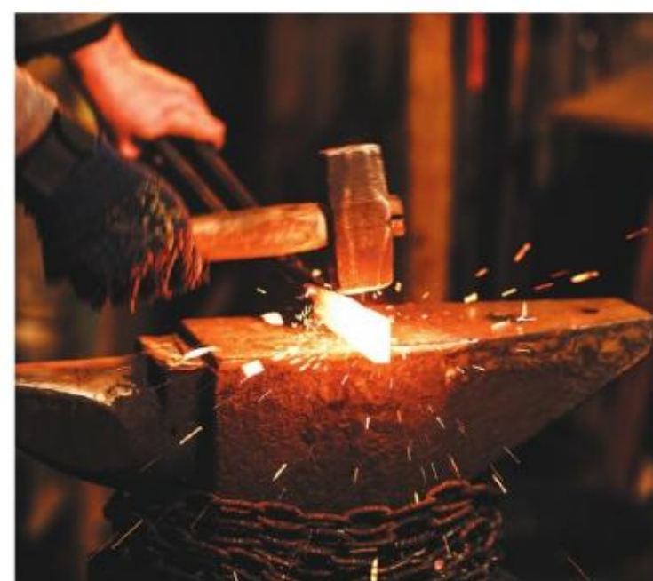
1.4 Kowal kujący metal najpierw ogrzewa go w płomieniu, a potem uderza w niego młotem
