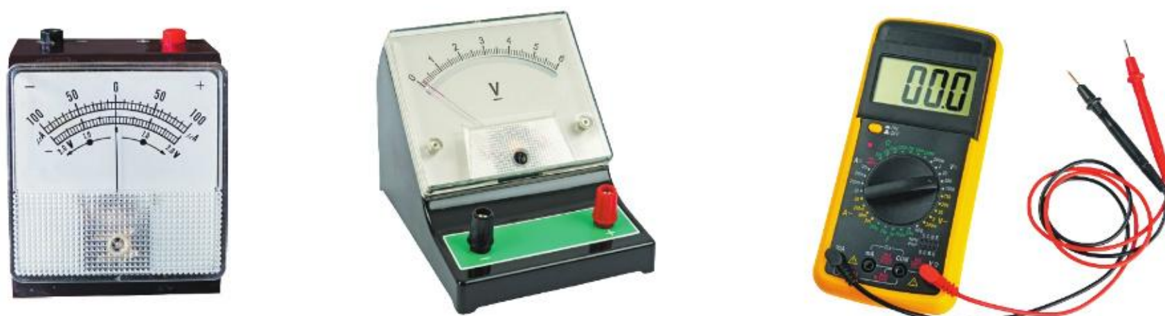
4.7 Przykłady przyrządów pomiarowych stosowanych jako woltomierze
