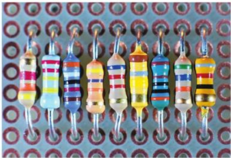
4.21 Wartość oporu opornika zapisywana jest w postaci kolorowego kodu
