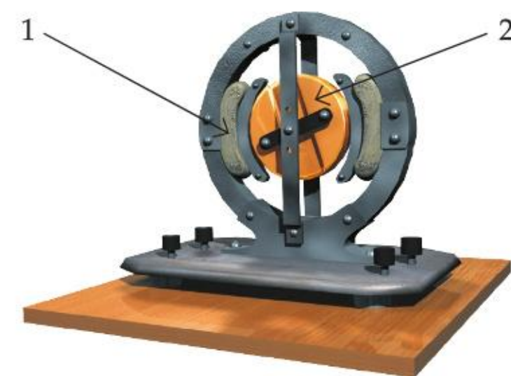
5.28 Szkolny model silnika. Elektromagnesy (1) i zwoje ułożone w żłobkach cylindrycznego rdzenia (2)
