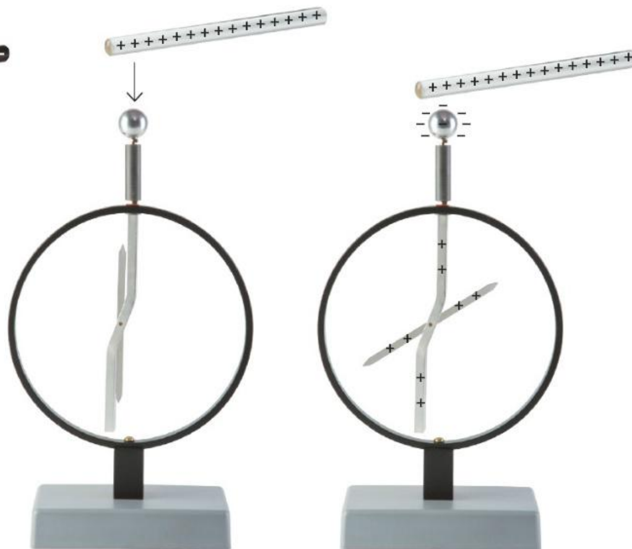
3.28 Rozdział ładunków w elektroskopie pod wpływem ciała naelektryzowanego dodatnio
