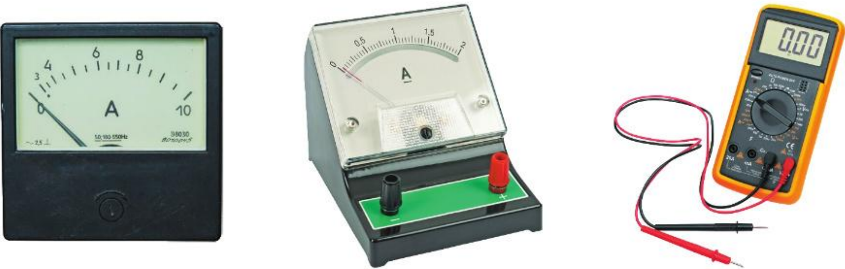
4.17 Przykłady przyrządów pomiarowych stosowanych jako amperomierze
