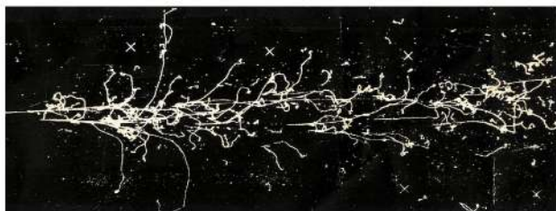
Rys. 22.4 Procesy krecji par elektron–pozyton
