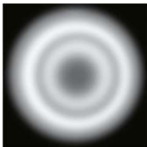
Rys. 10.4 Obraz interferencji wiązki elektronów przechodzących przez cienkie metalowe folie
