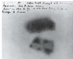
Rys. 17.2 Klisza fotograficzna naświetlona przez promieniowanie emitowane z próbki rudy uranowej
