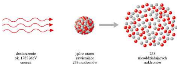
Rys. 23.1 Wizualizacja efektu dostarczenia do jądra uranu energii równej energii wiązania
