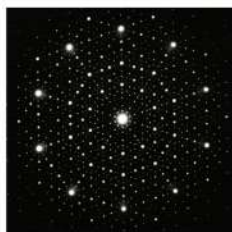
Rys. 10.2 Obraz dyfrakcji elektronów rozproszonych na kryształach
