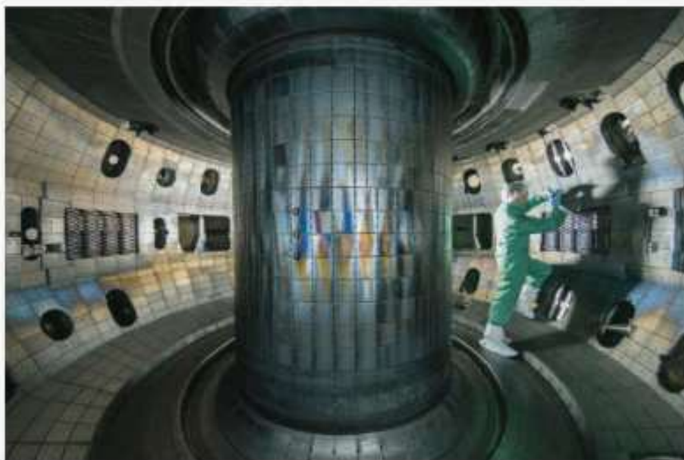
Rys. 38. Tokamak – widok wnętrza.
