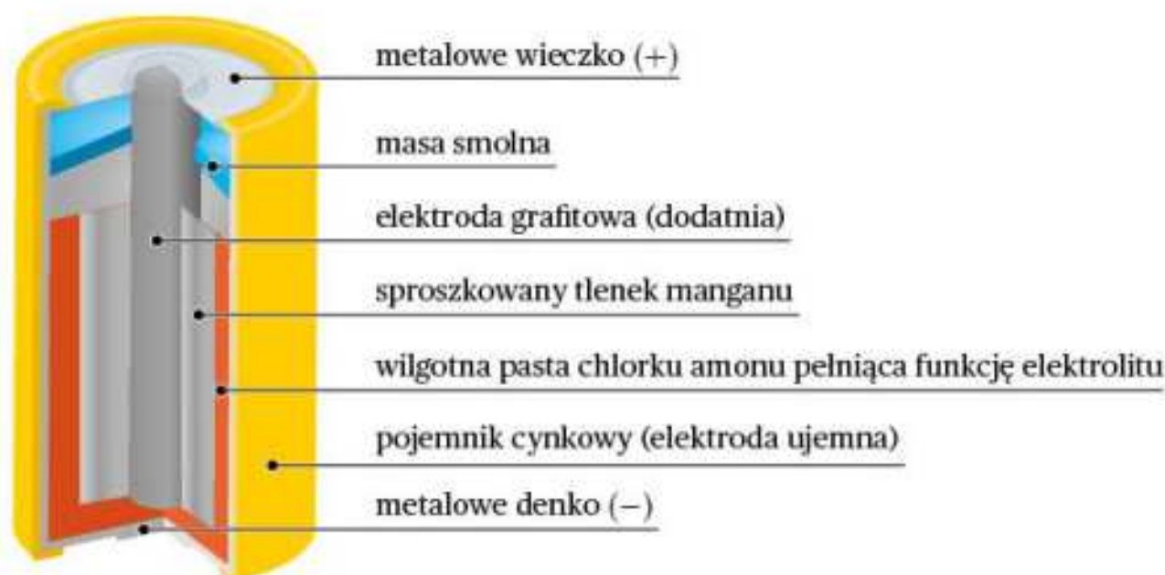
Rys. 28. Przekrój ogniwa Leclanchégo.
