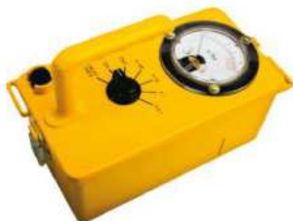
Rys. 23. Licznik Geigera–Müllera – detektor służący do wykrywania promieniowania w terenie.
