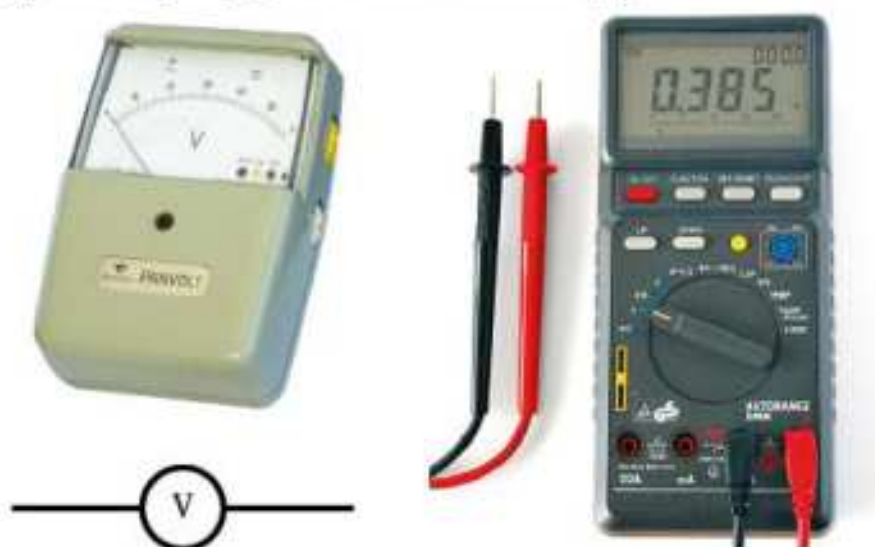
Rys. 5. Woltomierz analogowy i cyfrowy oraz symbol graficzny woltomierza stosowany na schematach.
