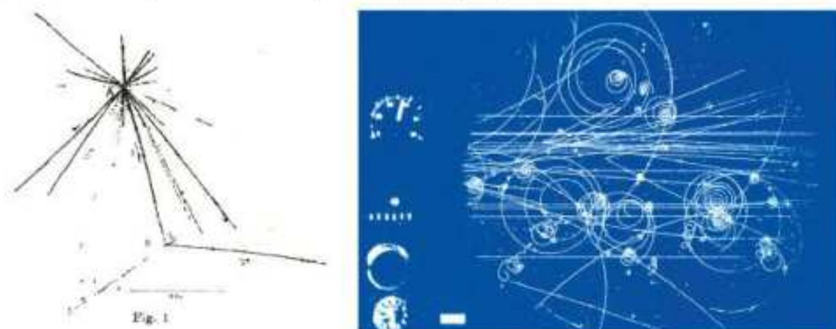
Rys. 14. a) Zarejestrowany na kliszy jądrowej efekt oddziaływania promieniowania kosmicznego z materią. b) Fotografia torów cząstek zarejestrowana w innym typie detektora śladowego: komorze pęcherzykowej.
