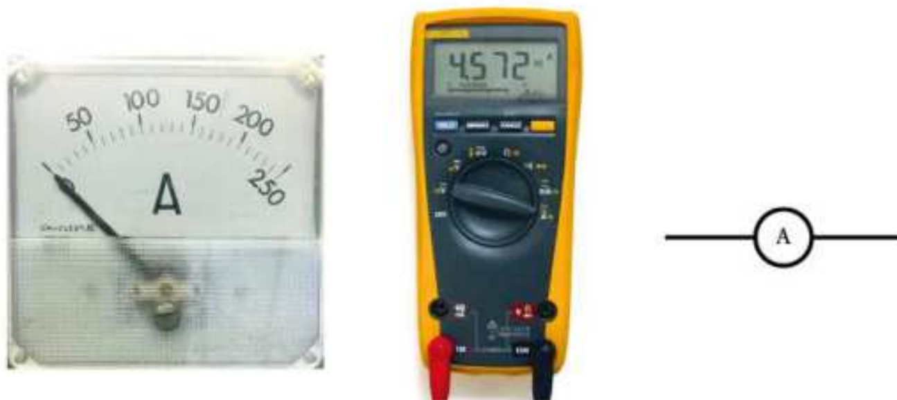
Rys. 3. Amperomierz analogowy i cyfrowy oraz symbol amperomierza stosowany na schematach obwodów elektrycznych.
