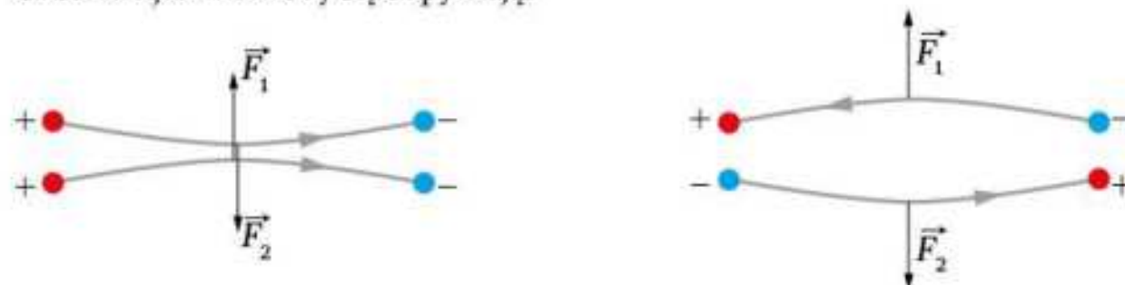
Rys. 15. Doświadczalne badanie oddziaływania magnetycznego między dwoma przewodnikami z prądem: a) gdy prądy płyną w tę samą stronę, przewody się przyciągają, b) gdy prądy płyną w przeciwnie strony, przewody się odpychają.
