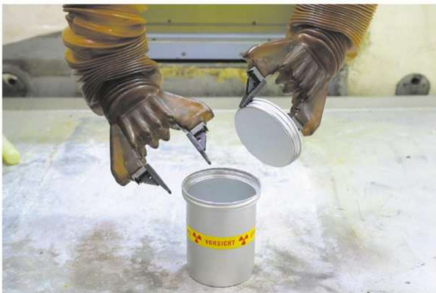
Rys. 5. Manipulator do przenoszenia pojemników z preparatami promieniotwórczymi. Na pojemnikach umieszczone są znaki ostrzegające przed promieniowaniem jonizującym.
