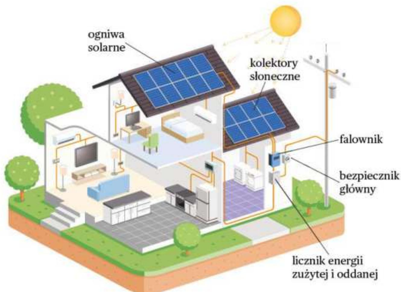
Rys. 6. Wykorzystanie energii słonecznej w domu jednorodzinnym.
