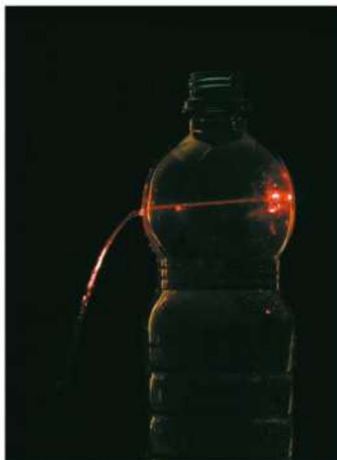
Rys. 5. Strumień wody pełni funkcję światłowodu.
