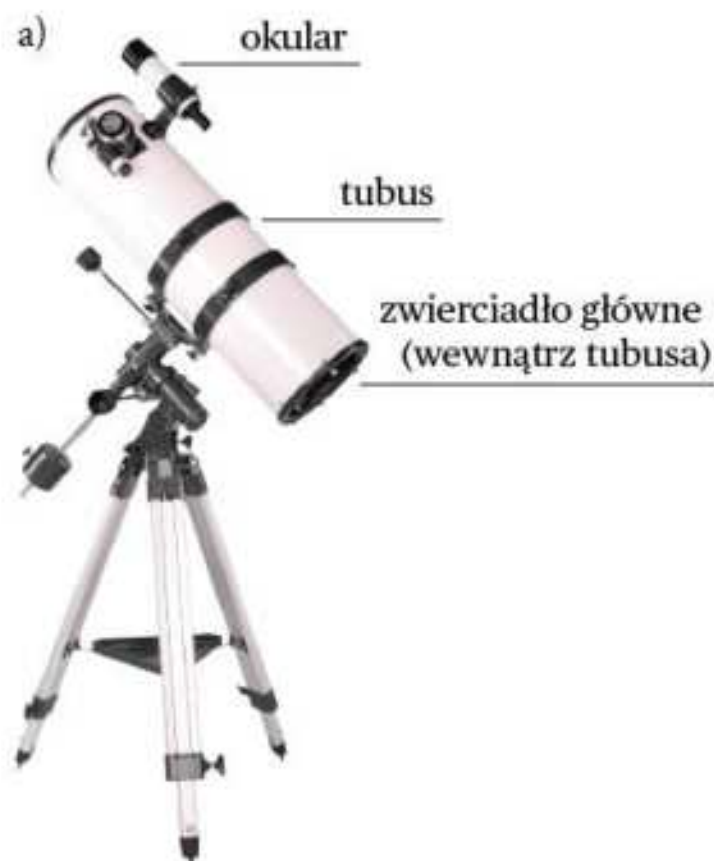
Rys. 8. a) Teleskop zwierciadlany. b) Bieg promieni świetlnych w teleskopie.
