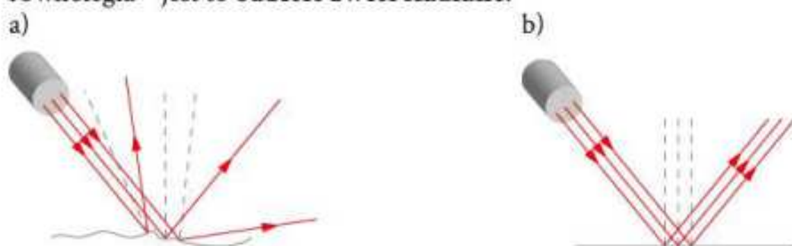
Rys. 1. Odbicie światła: a) rozproszone, b) zwierciadlane.
