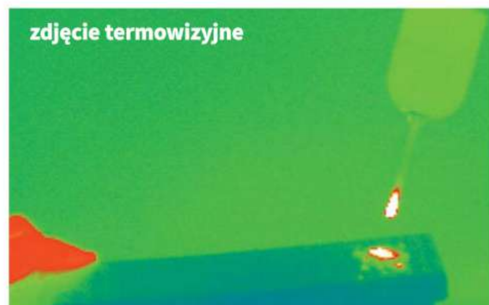
Rys. 33.1 Wzrost temperatury układu podczas wykonywania pracy mechanicznej
