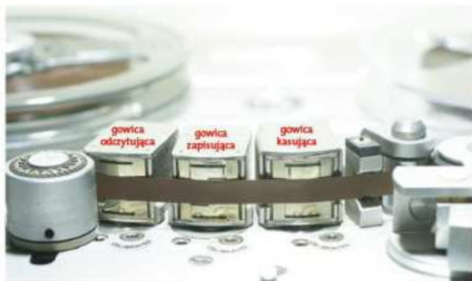
Rys. D.18. Zapis informacji na taśmie magnetycznej.
