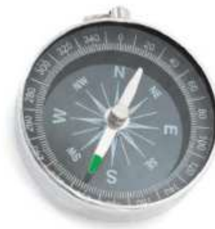
Rys. 2.7. Igła magnetyczna stanowi podstawową część kompasu i busoli – przyrządów służących do określania położenia stron świata. Busola to kompas wyposażony w dodatkowe urządzenia celownicze umieszczone na ruchomym pierścieniu.
