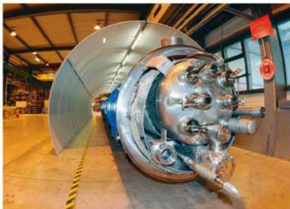
Rys. E.19. Tunel akceleratora LHC, w którym są montowane nadprzewodzące elektromagnesy.
