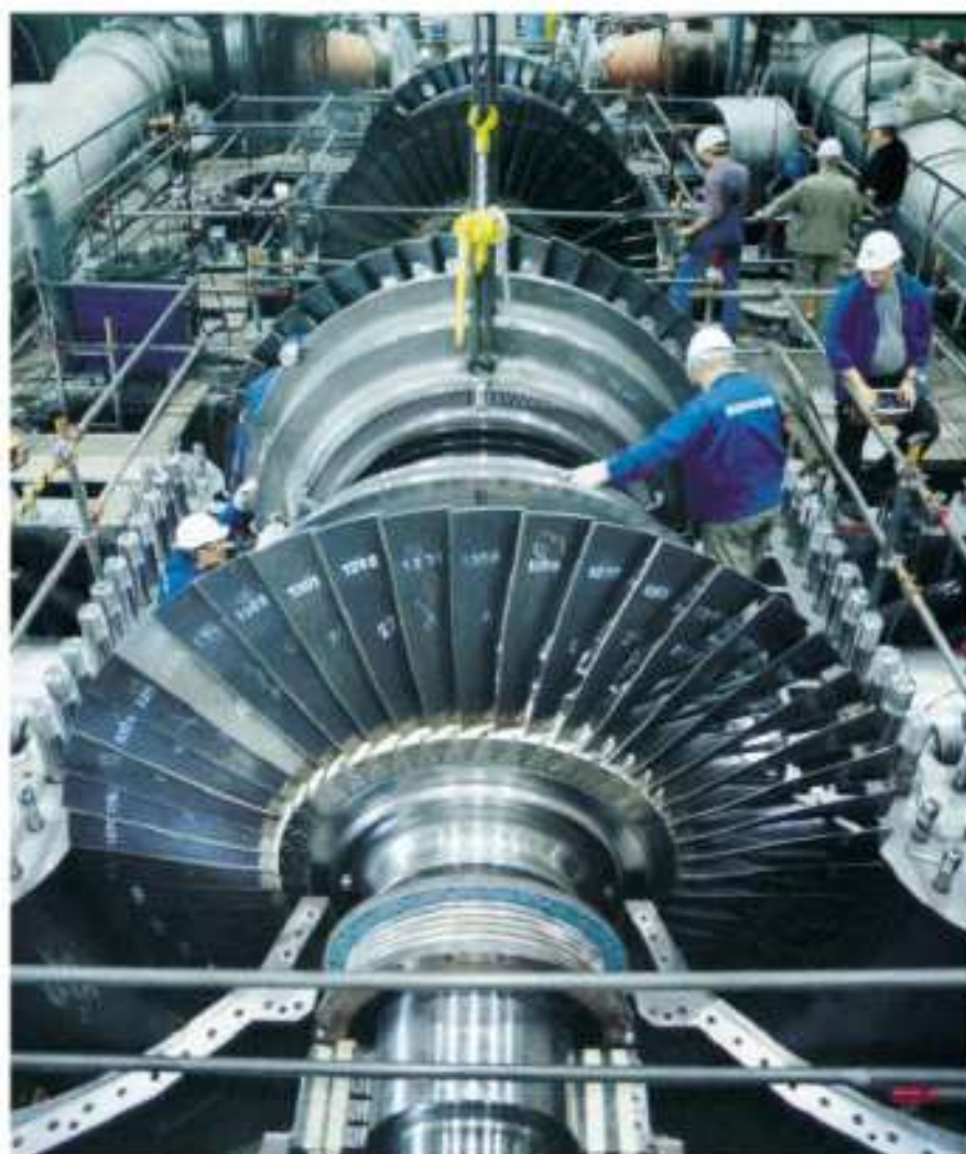
Rys. B.6. Wirnik turbiny Siemens zainstalowanej w elektrociepłowni.
