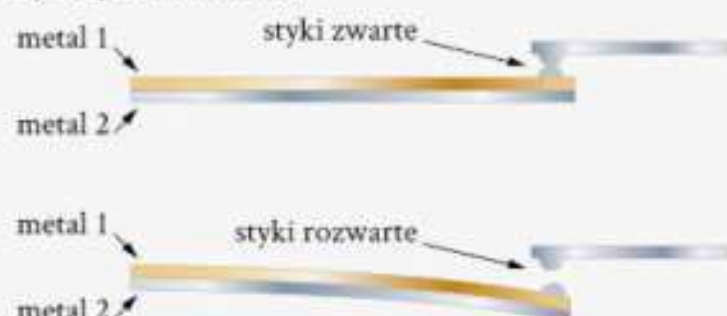
Rys. 4.17. Bimetal przy ogrzewaniu wygina się w jedną stronę, a przy oziębianiu – w drugą.
