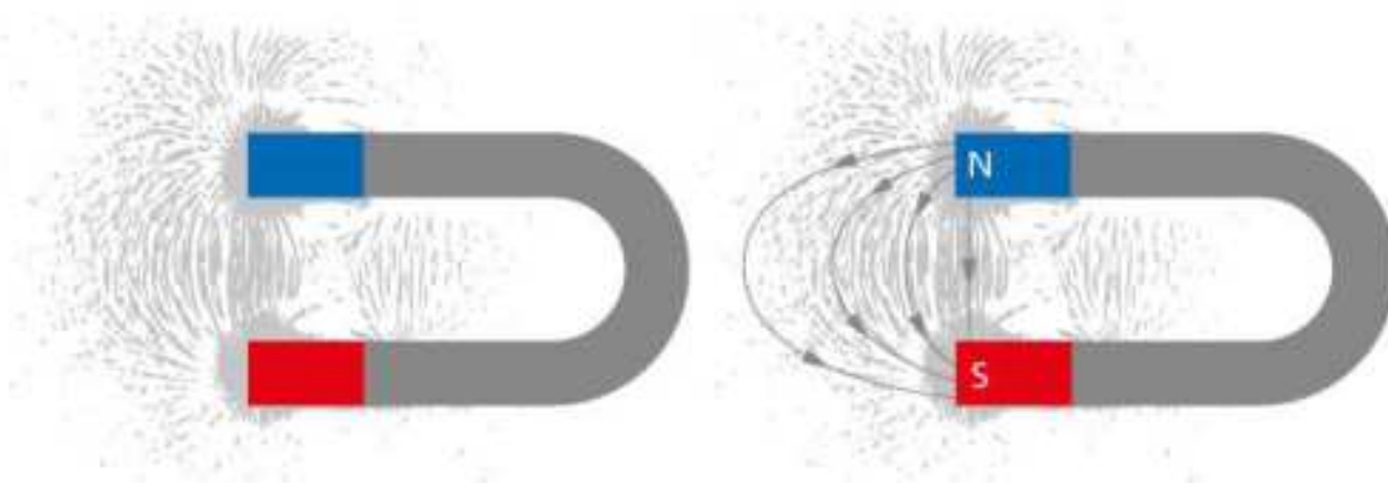
Rys. 2.12. Linie pola magnetycznego wokół magnesu podkowiastego.
