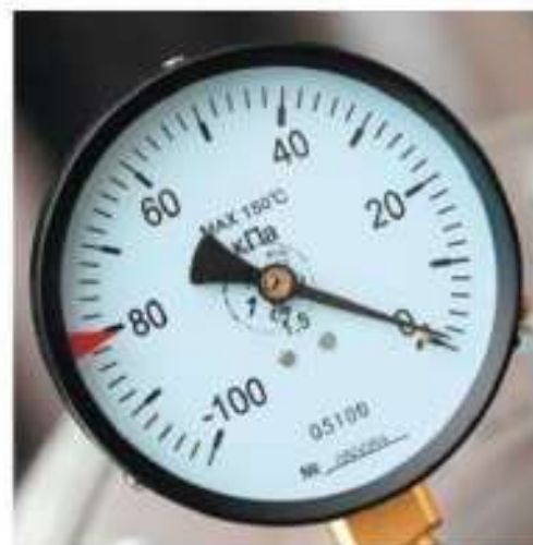
Rys. 4.4. Manometr służący do pomiaru ciśnienia powietrza w kole samochodowym.
