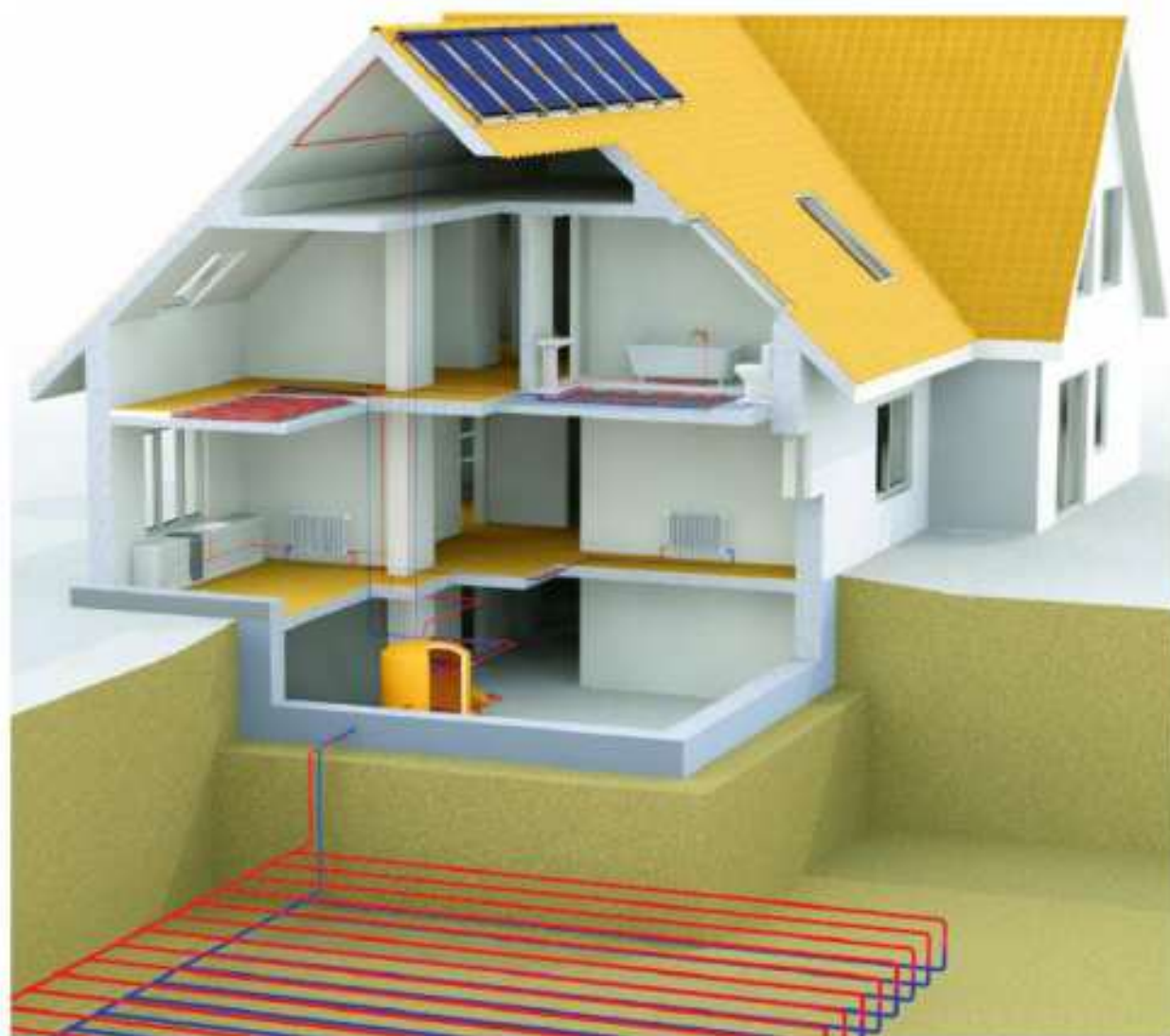
Rys. C.14. Nowoczesna instalacja centralnego ogrzewania rozprawdzająca ciepło w domu jednorodzinnym. Piecem jest w tym wypadku pompa ciepła, która czerpie ciepło z gruntu i z paneli słonecznych. Następnie podgrzewa wodę w zasobnikach instalacji CO oraz CWU (cieplej wody użytkowej), która zostaje rozprawdzona po całym budynku do grzejników, ogrzewania podłogowego oraz kranów.
