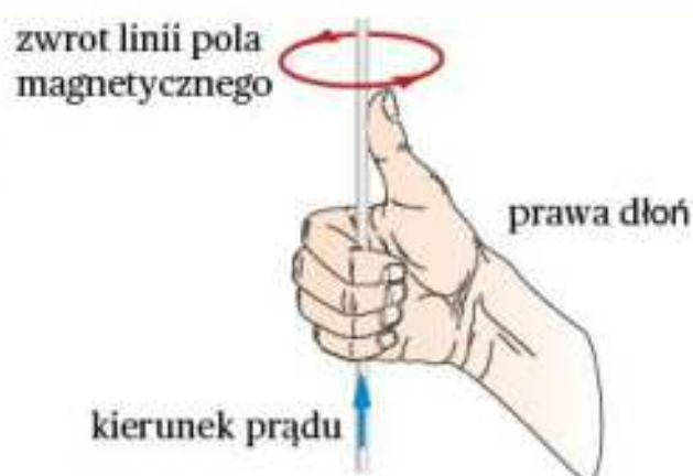
Rys. 2.19. Reguła prawej dłoni do wyznaczania zwrotu linii pola magnetycznego.
