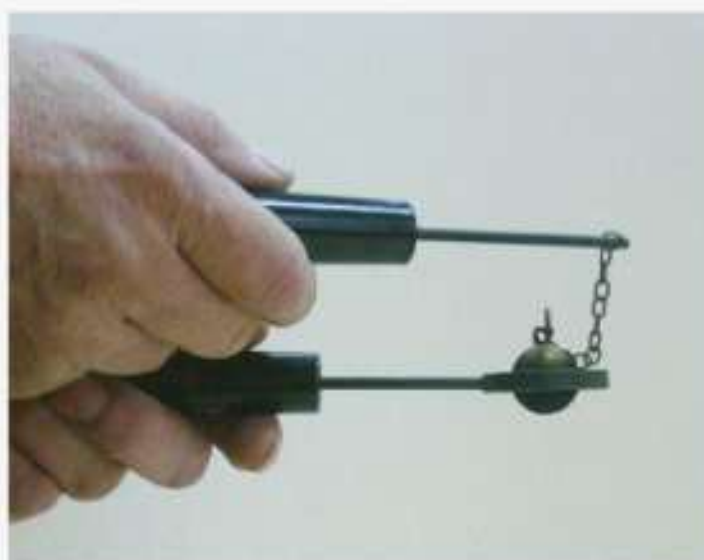
Rys. 4.14. Badanie zjawiska rozszerzalności objętościowej ciała stałego. Kula o niskiej temperaturze przechodzi bez przeszkód przez pierścień. Po jej ogrzaniu nad płomieniem nie jest to możliwe.
