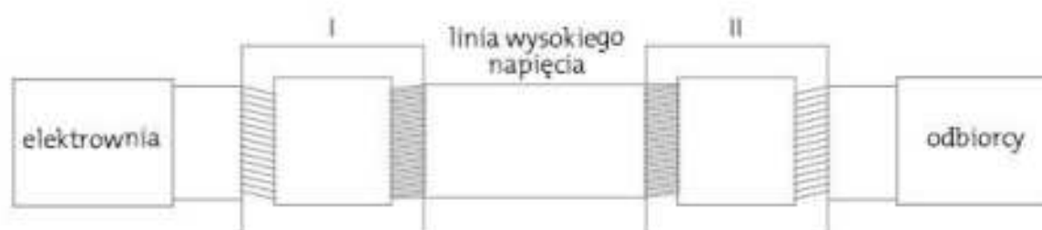
Rys. 3.11. Uproszczony schemat przesyłania prądu elektrycznego na duże odległości.
