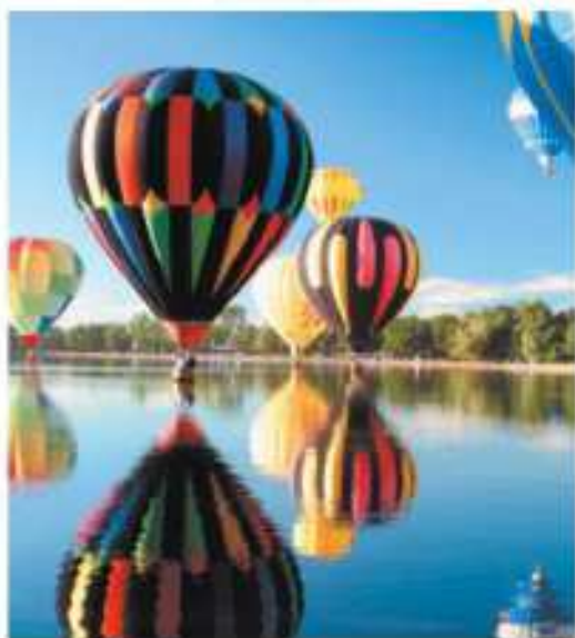
Rys. 4.10. Podgrzane powietrze w balonie jest lżejsze, dzięki czemu balon wznosi się do góry.
