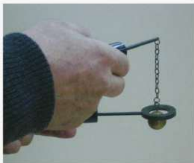
Rys. 4.14. Badanie zjawiska rozszerzalności objętościowej ciała stałego. Kula o niskiej temperaturze przechodzi bez przeszkód przez pierścień. Po jej ogrzaniu nad płomieniem nie jest to możliwe.
