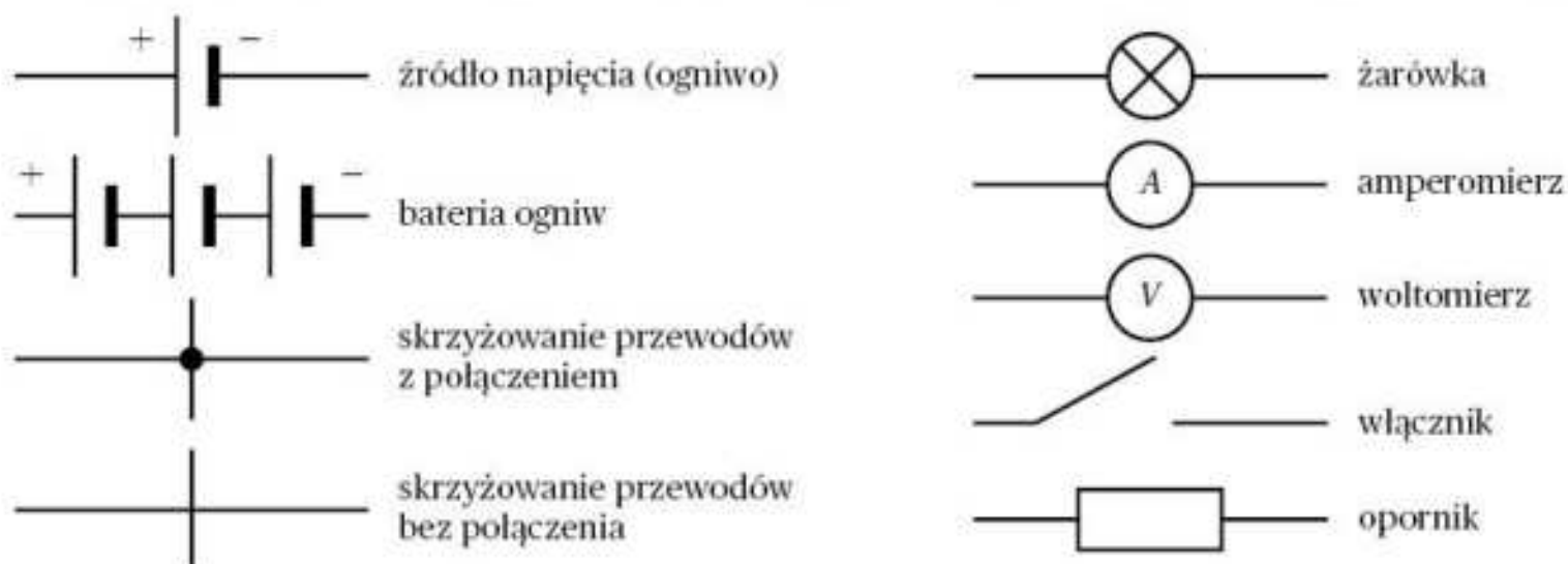
Rys. 1.18. Podstawowe symbole stosowane podczas rysowania schematów obwodów elektrycznych.
