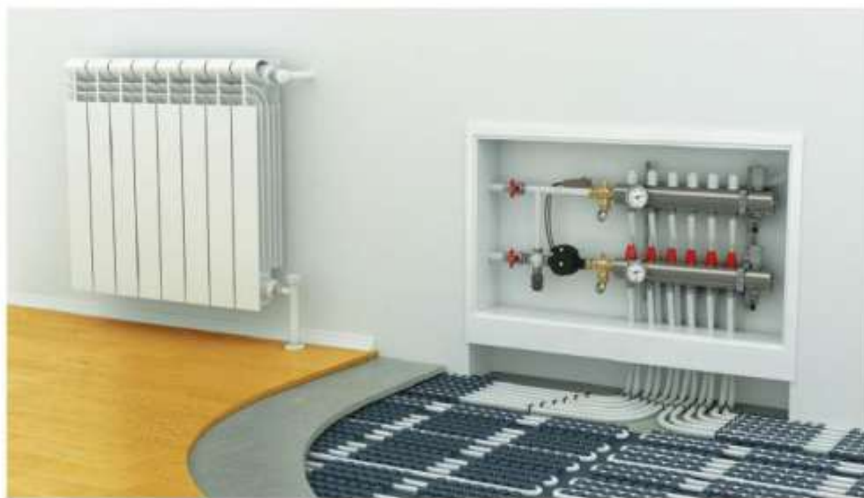
Rys. C.15. Grzejniki, skrzynka rozdzielcza obwodów ogrzewania podłogowego oraz rurki ogrzewania podłogowego ułożone w warstwie wylewki. Grzejniki mają żeberka, dzięki którym zwiększa się ich powierzchnię, aby szybciej oddawać ciepło. Muszą jednak być zasilane wodą o wysokiej temperaturze, znacznie większej od tej, którą wprowadza się w obwody ogrzewania podłogowego.
