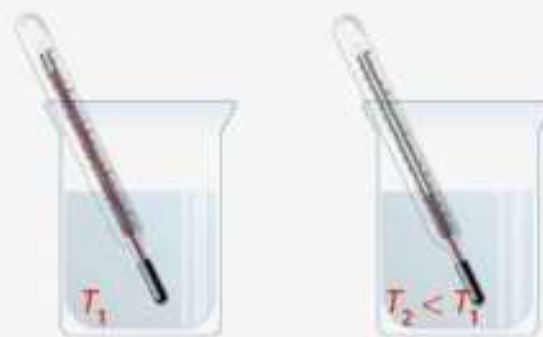
Rys. 4.11. Zjawisko rozszerzalności objętościowej cieczy jest wykorzystane w termometrach.
