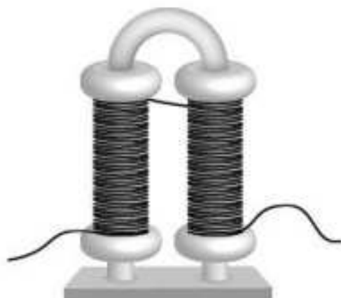
Rys. 2.25. a) Budowa elektromagnesu. b) Elektromagnesy mają wiele zastosowań, mogą np. służyć do przenoszenia stalowych elementów.
