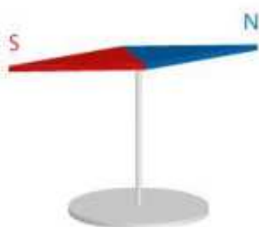
Rys. 2.6. Tak jak każdy magnes, igła magnetyczna również ma bieguny magnetyczne N i S.
