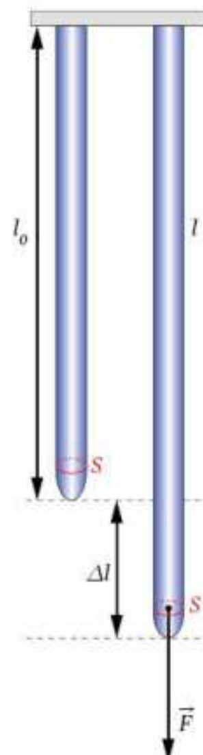
Rys. E.4. Układ do badania prawa Hooke'a.
