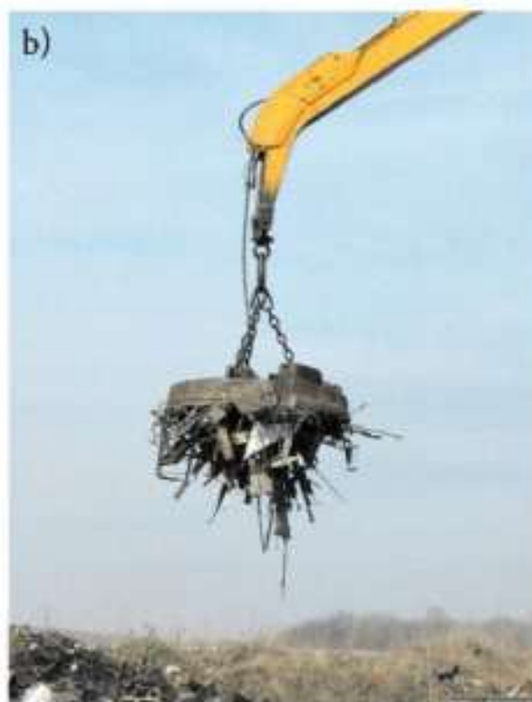
Rys. 2.25. a) Budowa elektromagnesu. b) Elektromagnesy mają wiele zastosowań, mogą np. służyć do przenoszenia stalowych elementów.
