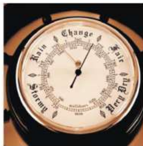
Rys. 4.5. Barometr służący do pomiaru ciśnienia atmosferycznego.
