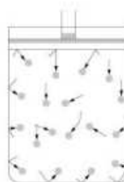
Rys. 4.3. Cząsteczki, uderzając w ścianki naczynia, wywierają ciśnienie.
