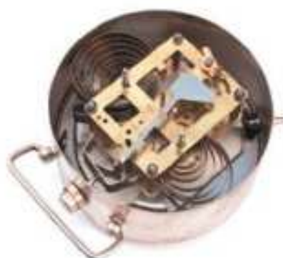
Rys. 4.8. Odkształcona sprężyna zegara ma energię potencjalną sprężystości.
