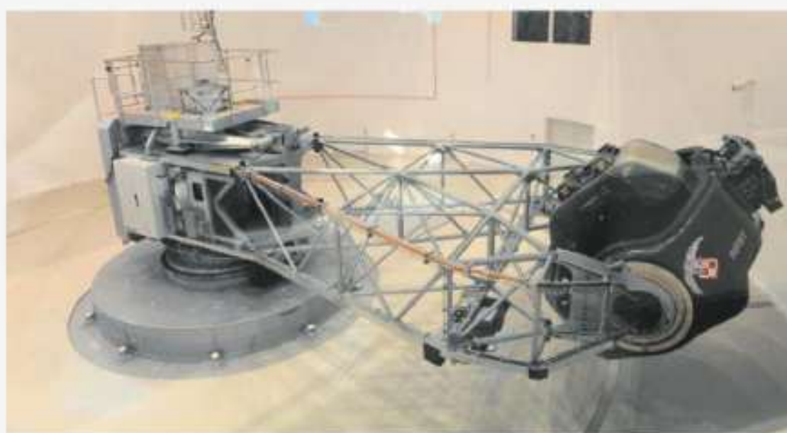
Rys. 5.5. W wirówce znajdującej się w Wojskowym Instytucie Medycyny Lotniczej w Warszawie można uzyskać przeciążenia do 16g .
