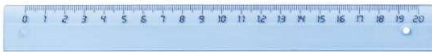
Rys. 1.16. Działka elementarna na skali linijki wynosi 1 mm.
