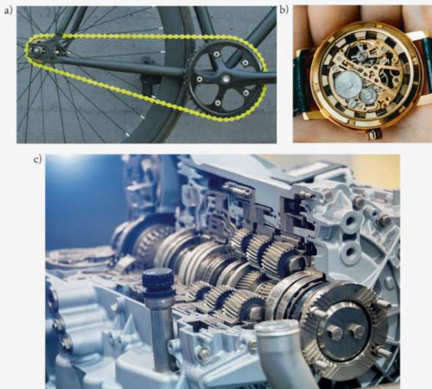
Rys. 4.29. Przykłady zastosowań przekładni: a) przekładnia łańcuchowa w rowerze, b) przekładnie zębate w zegarku mechanicznym, c) samochodowa skrzynia biegów.
