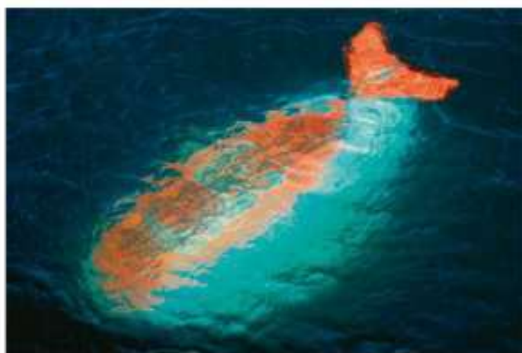
Rys. B.27. Zmieniając średnią gęstość łodzi podwodnej, przez napełnianie zbiorników balastowych wodą, lub opróżniając je z wody sprężonym powietrzem, można osadzić łódź na dnie, wynurzyć na powierzchnię lub utrzymywać między dnem a powierzchnią wody.
