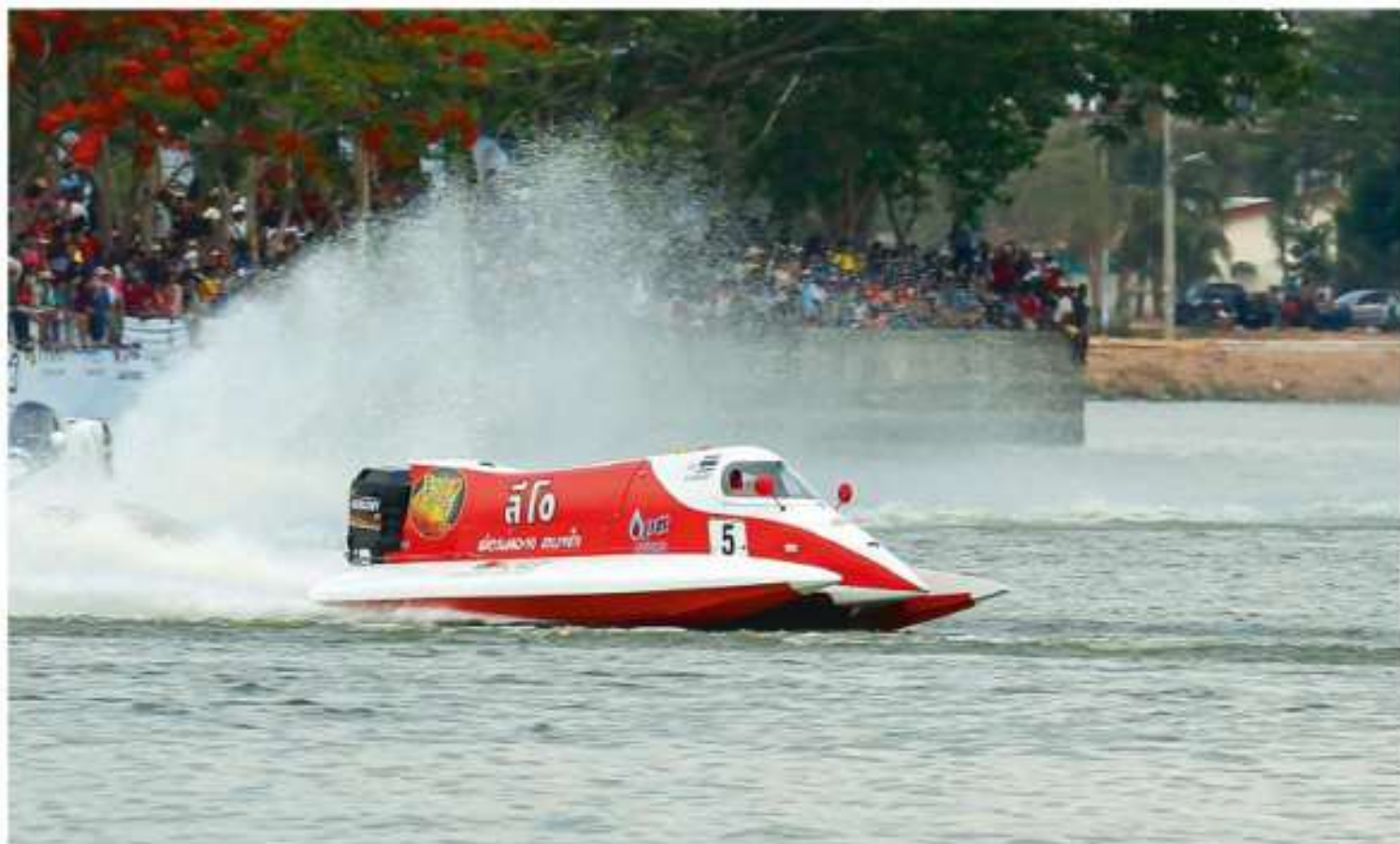
Rys. B.7. Motorówki, w szczególności wyścigowe, mają opływowe kształty.
