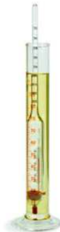
Rys. B.26. Areometr służy do wyznaczania gęstości cieczy.
