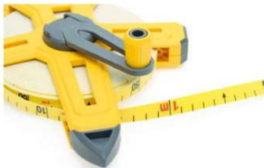
Rys. 1.15. Działka elementarna na skali taśmy mierniczej wynosi 1 cm.
