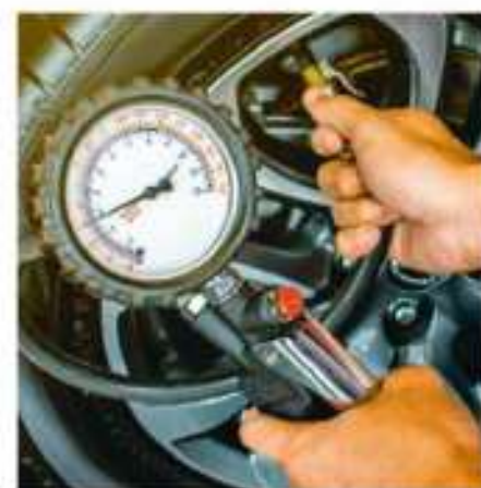
Rys. B.10. Manometr służący do pomiaru ciśnienia powietrza w kole samochodowym.
