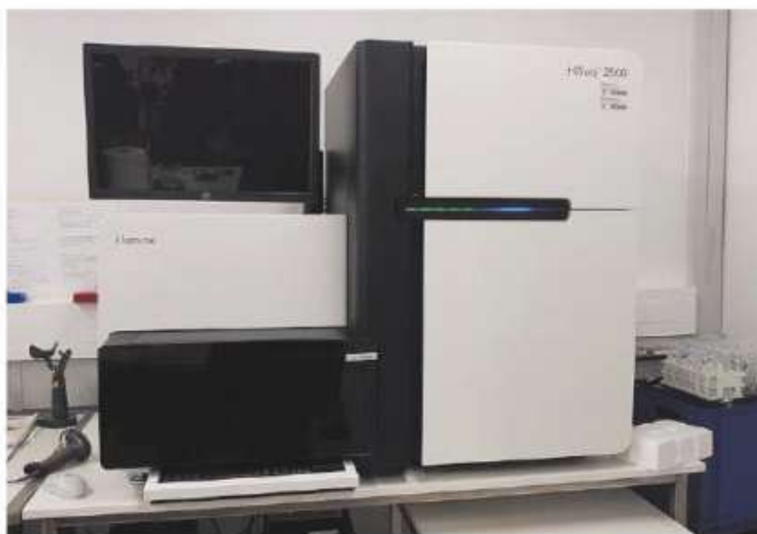
Ryc. I.1.5. Sekwencjator służy do analizy kolejności nukleotydów w DNA.
