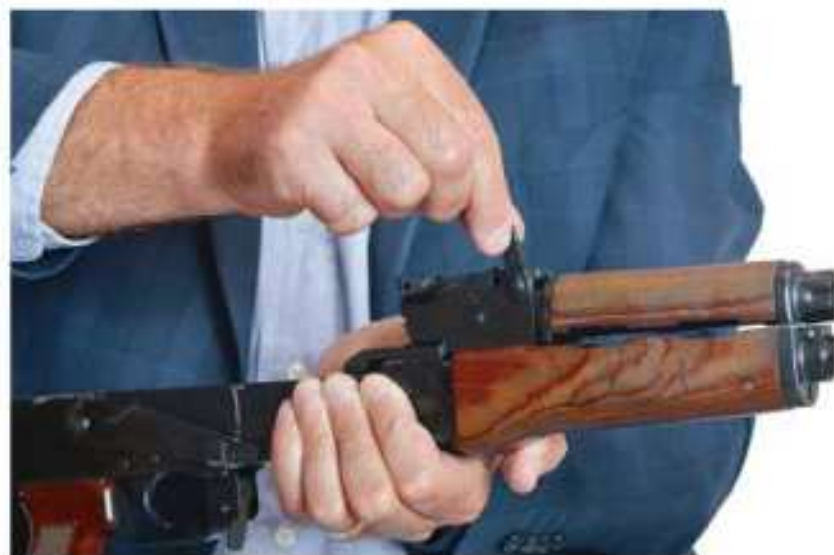
Odłączanie rury gazowej
