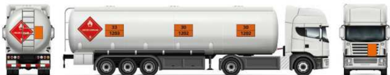
Samochód cysterna z dwoma substancjami płynnymi rozmieszczonymi w trzech zbiornikach
