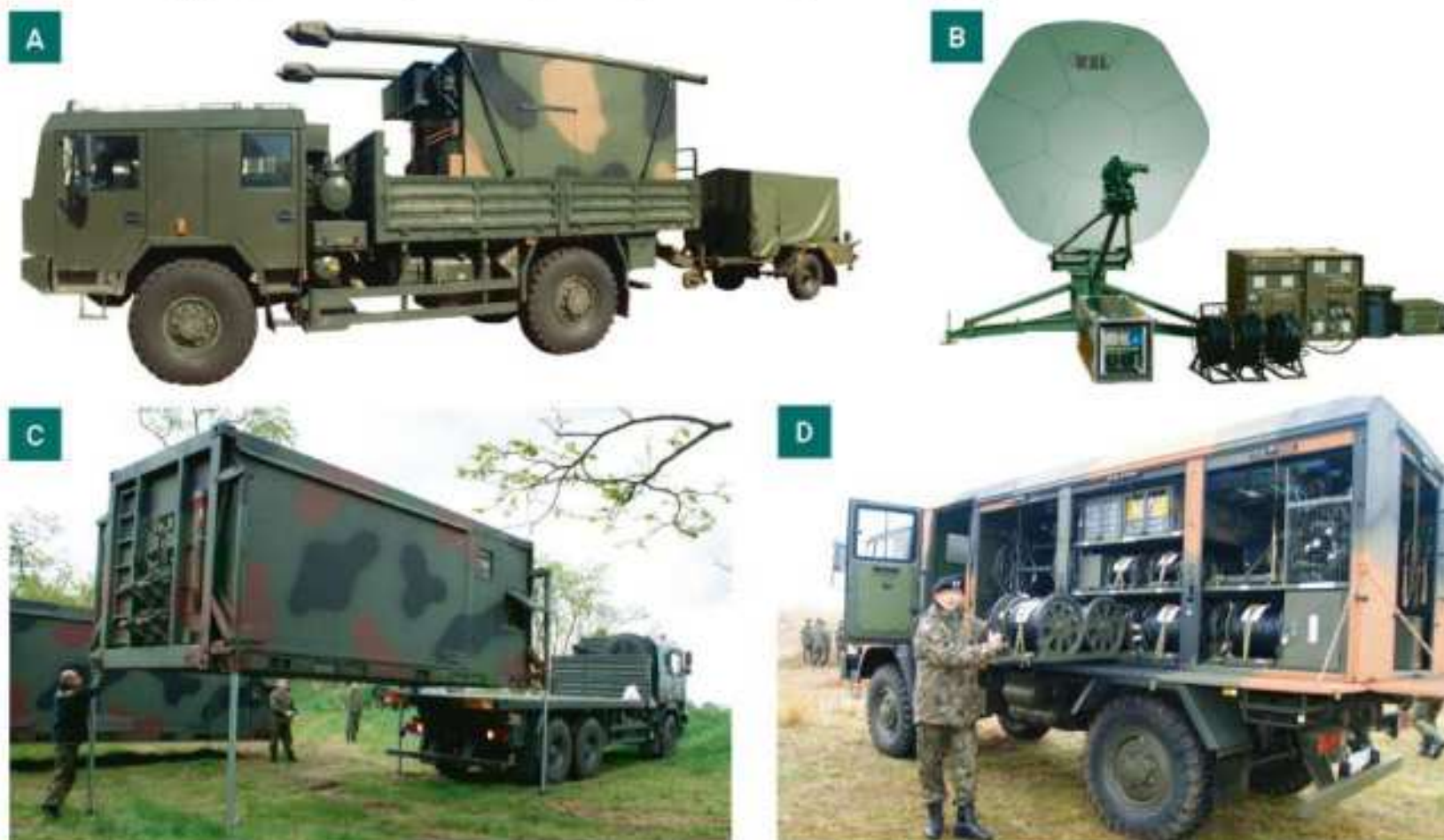
A. Ruchomy węzeł łączności cyfrowej w wersji transmisyjnej RWŁC-10/T – mobilne centrum telekomunikacyjne; B. Przenośno-przewoźny Terminal Satelitarny PPRS-1.8; C. Mobilny moduł SD (MMSD) do zabezpieczenia miejsc pracy dowódczo-sztabowej w warunkach polowych; D. Węzłowy wóz kablowy WWK-10/C
