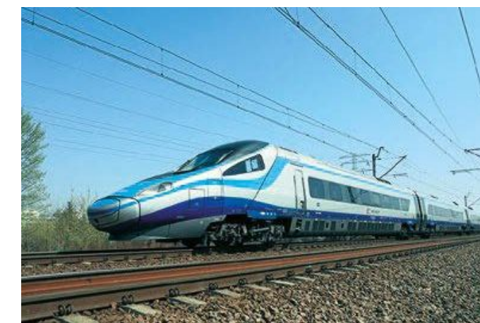
Na niektórych zmodernizowanych liniach kolejowych pociągi Express InterCity Premium (Pendolino) osiągają prędkość około 200 km/h.
