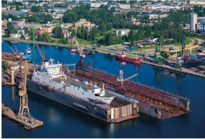
W Gdańskiej Stoczni Remontowej do naprawy statków wykorzystuje się dok pływający.
