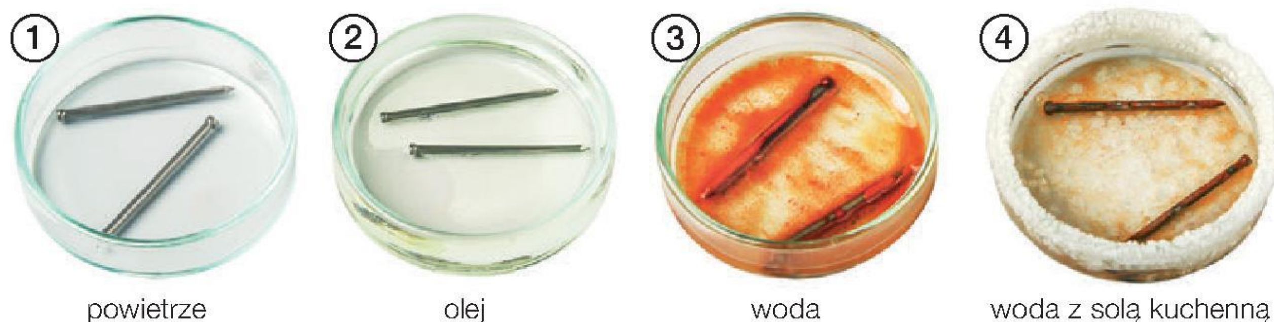
Fot. 35. Badanie wpływu na żelazo: powietrza, oleju, wody i mieszaniny wody z solą.
