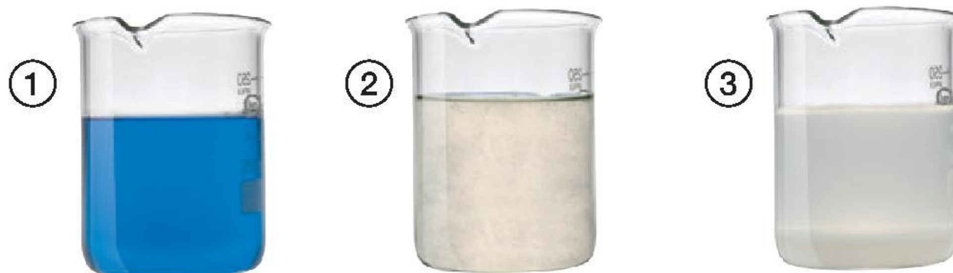
Fot. 111. Roztwór właściwy ①, koloid ②, zawiesina ③.
