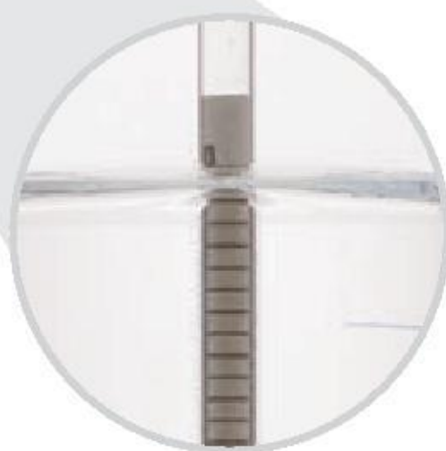
Fot. 120. Pomiar gęstości cieczy.
