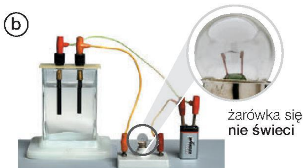
Fot. 128. Badanie zjawiska przewodzenia prądu elektrycznego przez roztwory wodne związków chemicznych: a elektrolity, b nieelektrolity.
