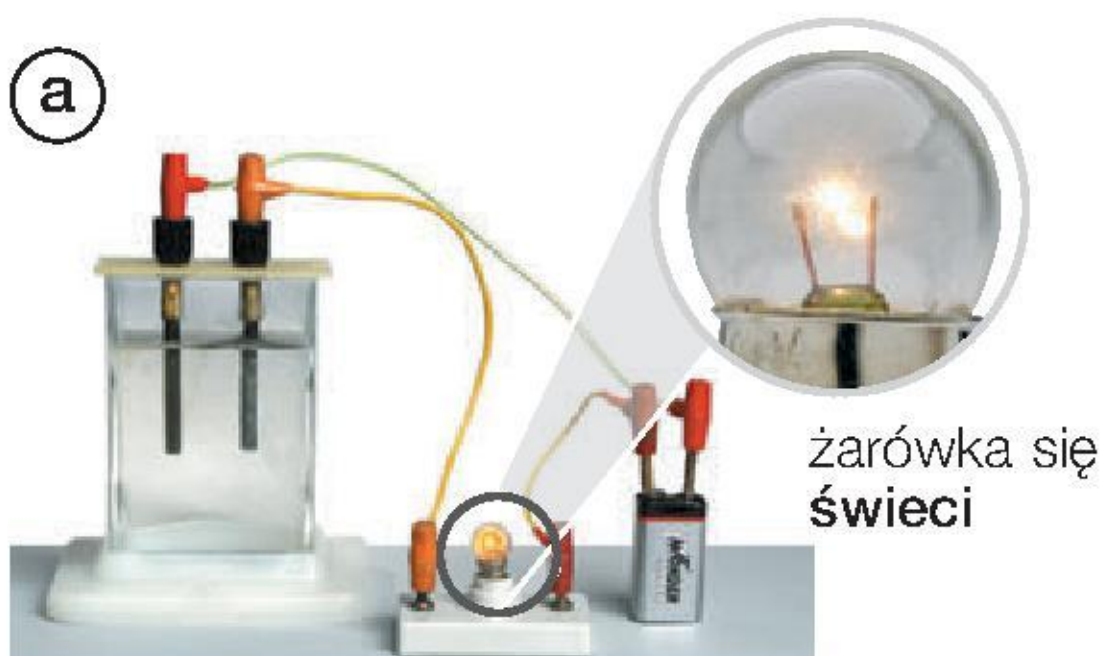
Fot. 128. Badanie zjawiska przewodzenia prądu elektrycznego przez roztwory wodne związków chemicznych: a elektrolity, b nieelektrolity.
